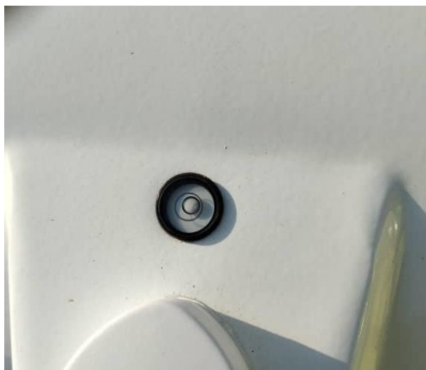
Figure 20: Mise à niveau du tracker / Tracker leveling
