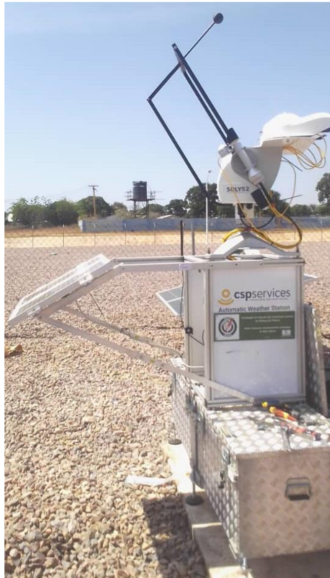
Figure 37 : Structure de montage, suiveur solaire, capteurs et boîtier de contrôle avec le logo WAPP / Mounting structure, solar tracker, sensors and control box with WAPP logo.
