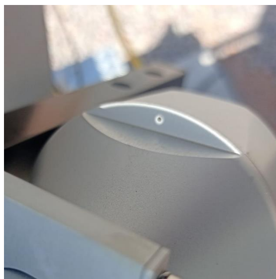
Figure 28 : Alignement du pyrhéliomètre / Pyrheliometer alignment
