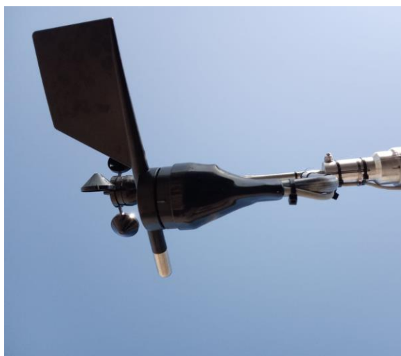
Figure 13: Marque nord du capteur de direction du vent alignée avec le cantilever de montage et la direction du nord. / Wind direction sensor north mark aligned with mounting cantilever and north direction
