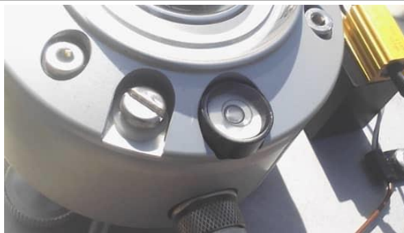
Figure 18: Mise à niveau du pyranomètre CMP10 (GHI) / CMP10 pyranometer leveling (GHI)
