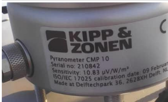
Figure 17: Numéro de série du pyranomètre CMP10 (DHI) / CMP10 pyranometer serial number (DHI)
