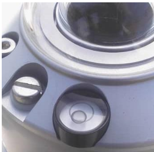
Figure 19: Mise à niveau du pyranomètre CMP10 (GHI) / CMP10 pyranometer leveling (DHI)
