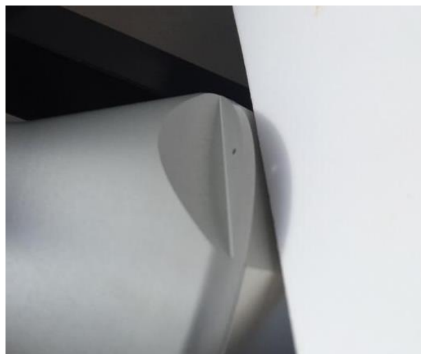
Figure 28 : Alignement du pyrhélimètre / Pyrheliometer alignment
