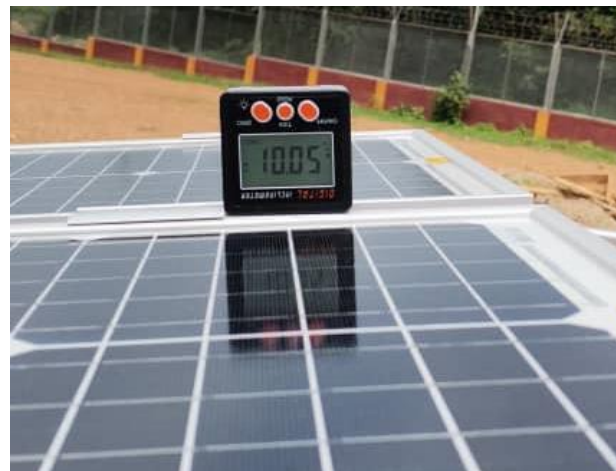
Figure 33: Structure de support PV-S avec un angle d'inclinaison de 10° vers le sud / PV-S support structure with 10° tilt angle towards South.
