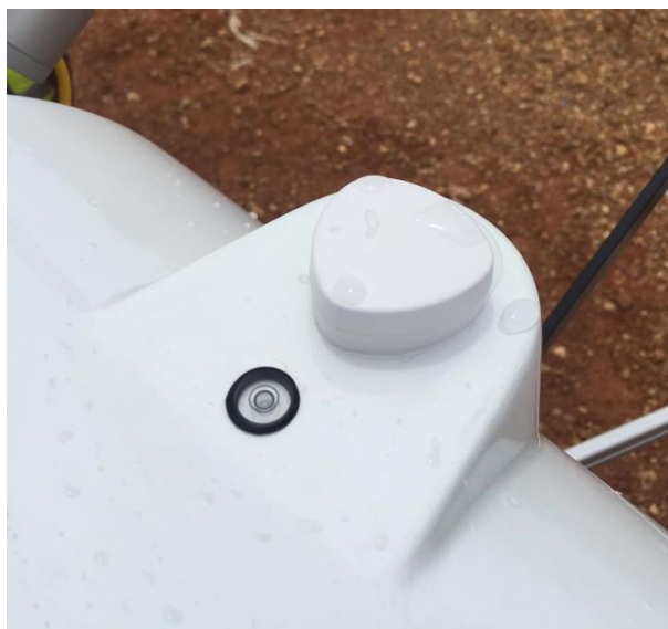
Figure 20: Mise à niveau du tracker / Tracker leveling
