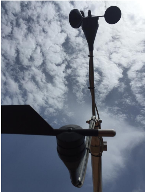
Figure 13: Marque nord du capteur de direction du vent alignée avec le cantilever de montage et la direction du nord. / Wind direction sensor north mark aligned with mounting cantilever and north direction
