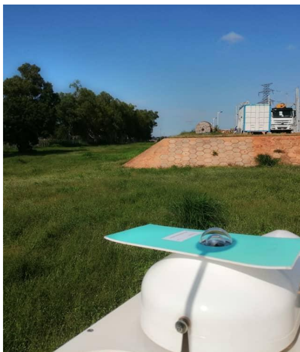
Figure 80: Alignement de l'assemblage de l'ombrage après correction / Shading assembly alignment after correction (2022-09-24).
