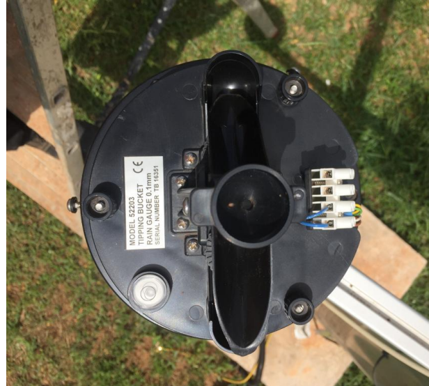
Figure 90: Mise à niveau du capteur de pluie / Rain sensor levelling.
