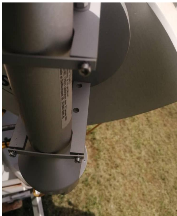
Figure 77: Vérification de l'alignement du pyrhéliomètre / Pyrheliometer alignment check (2022-08-09).
