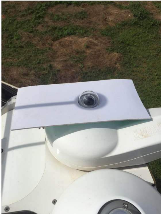
Figure 85: Alignement de l'assemblage de l'ombrage / Shading assembly alignment.
