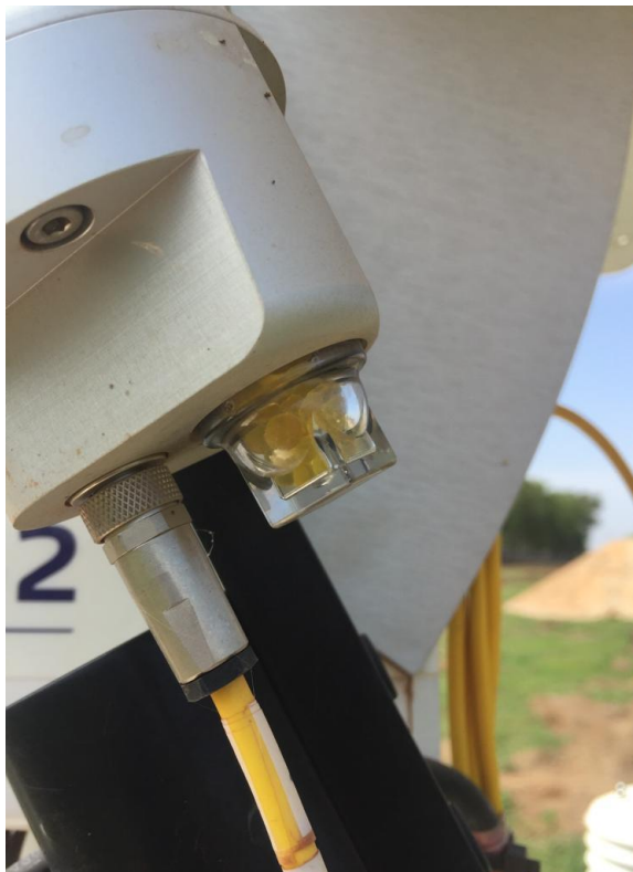
Figure 87 : Changement du dessiccant de pyrhéliomètre / Change of pyrheliometer desiccant.
