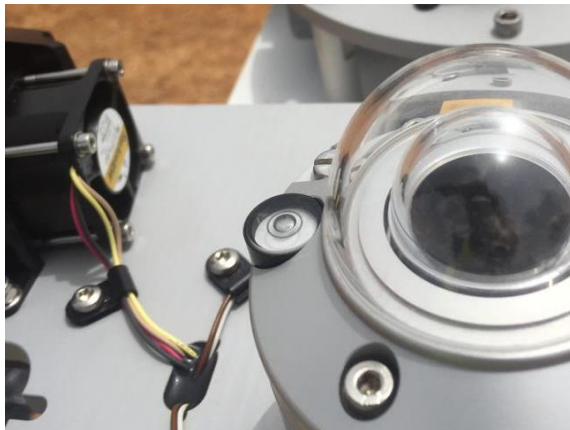
Figure 54: Mise à niveau du pyranomètre CMP10 (GHI) / CMP10 pyranometer leveling (DHI).
