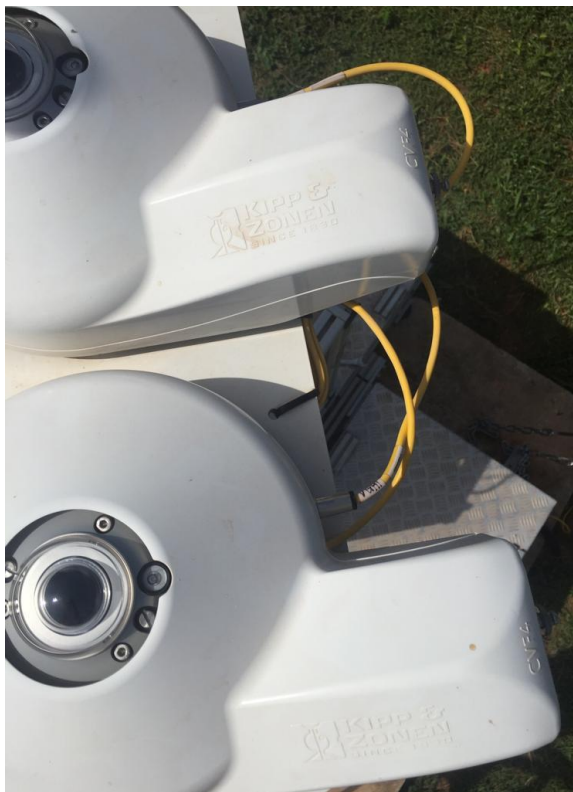
Figure 83: Mise à niveau des pyranomètres CMP10 / CMP10 pyranometer leveling.
