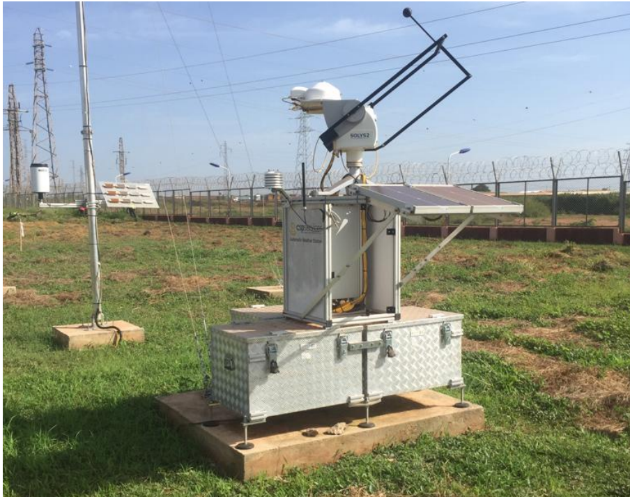
Figure 96: Structure de montage, tracker solaire, capteurs et boîtier de contrôle / Mounting structure, solar tracker, sensors and control box.
