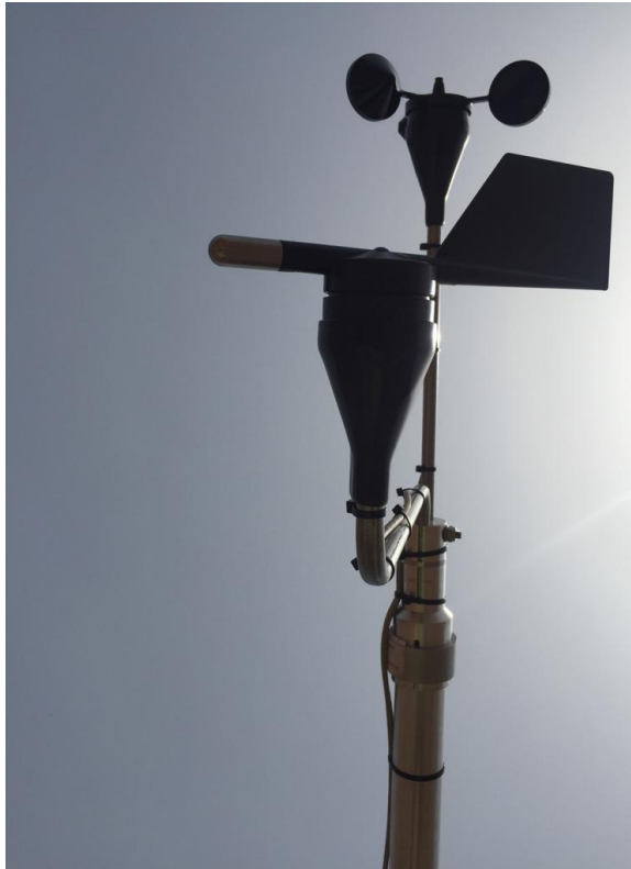
Figure 48: Marque nord du capteur de direction du vent alignée avec le cantilever de montage et la direction du nord. / Wind direction sensor north mark aligned with mounting cantilever and north direction.
