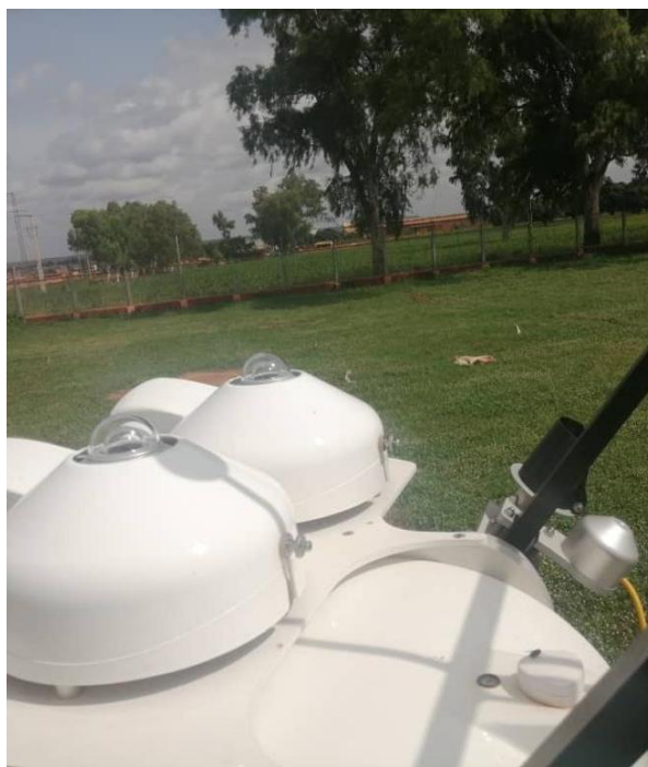
Figure 78: Alignement de l'assemblage de l'ombrage avant correction / Shading assembly alignment before correction (2022-08-09).
