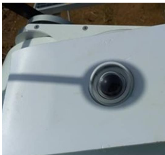
Figure 62: Mise à niveau du dispositif d'ombrage / Shading assembly alignment.
