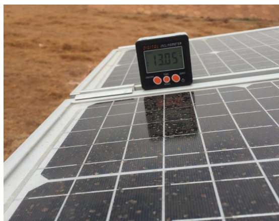
Figure 33: Structure de support PV-S avec un angle d'inclinaison de 13° vers le sud / PV-S support structure with 13° tilt angle towards South.
