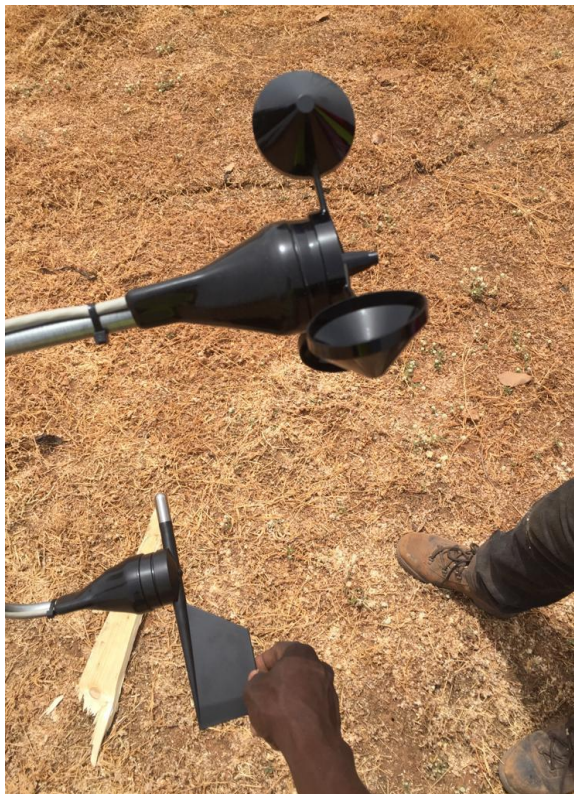
Figure 11: Préparatifs du mât du vent / Wind mast preparations
