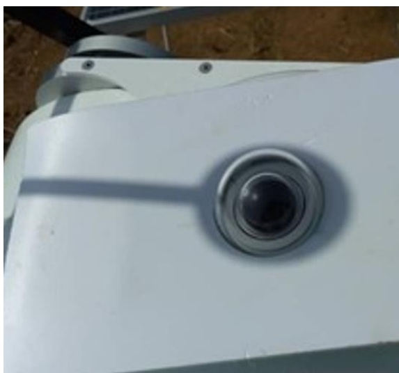
Figure 27: Mise à niveau du dispositif d'ombrage / Shading assembly alignment
