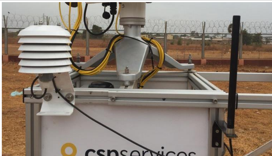
Figure 29: Capteur T/RH et antenne du modem / T/RH sensor and modem antenna
