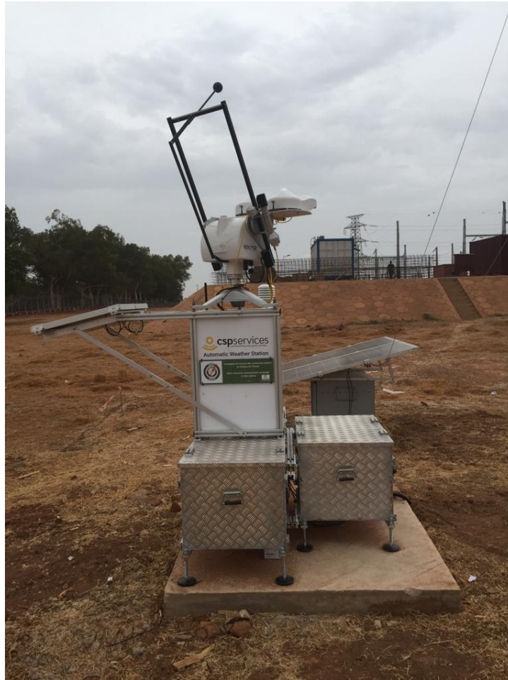
Figure 37 : Structure de montage, suiveur solaire, capteurs et boîtier de contrôle avec le logo WAPP / Mounting structure, solar tracker, sensors and control box with WAPP logo.
