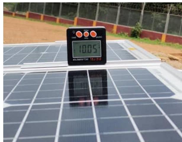
Figure 68: Structure de support PV-S avec un angle d'inclinaison de 10° vers le sud / PV-S support structure with 10° tilt angle towards south.
