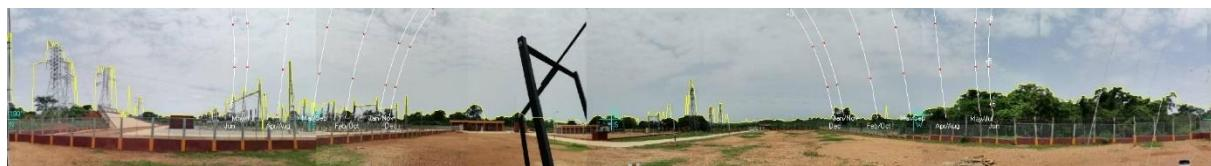
**Figure 5: Ligne d'horizon du point de vue du pyranomètre et course du soleil tout au long de l'année / Horizon line from the perspective of the pyranometer and sun path throughout the year.**
