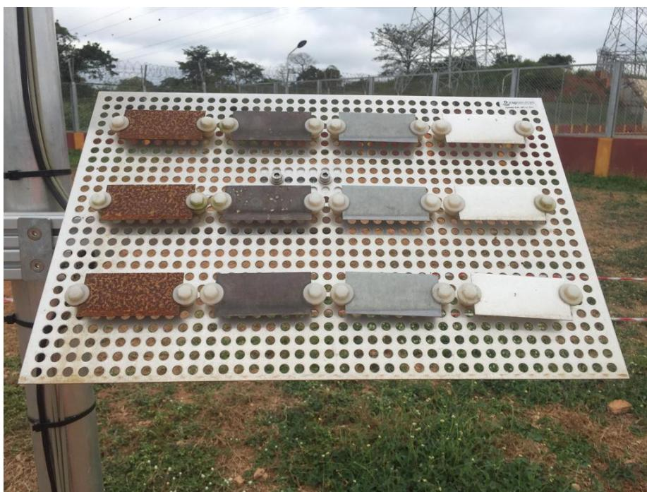
**Figure 88: Echantillonneur de corrosion / Corrosion sampler.**
