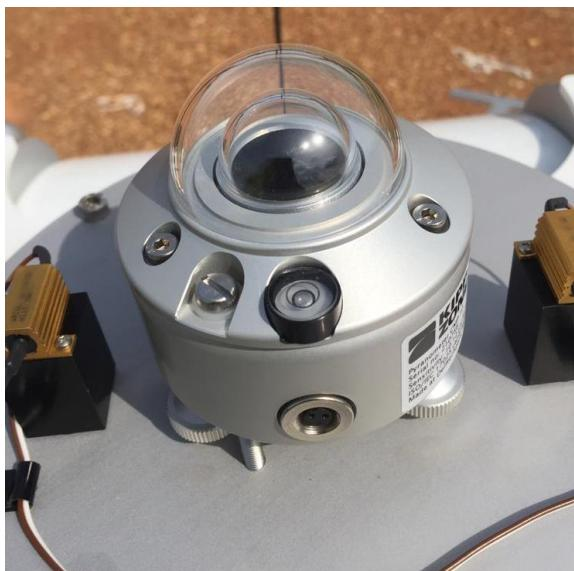
Figure 54: Mise à niveau du pyranomètre CMP10 (GHI) / CMP10 pyranometer leveling (DHI).
