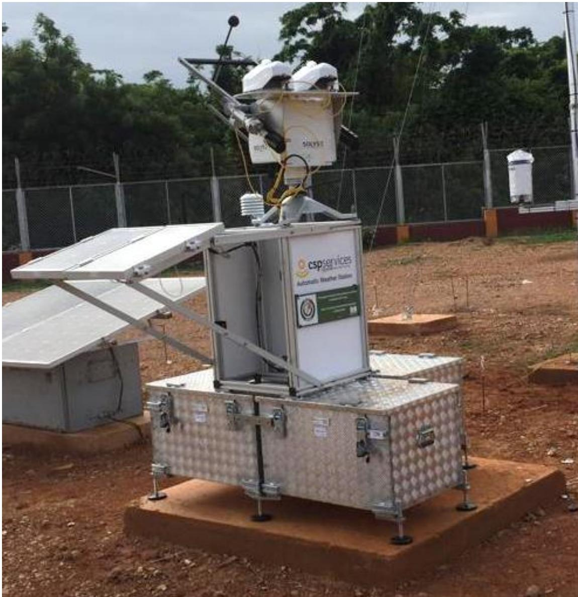
**Figure 72: Structure de montage, suiveur solaire, capteurs et boîtier de contrôle avec le logo WAPP / Mounting structure, solar tracker, sensors and control box with WAPP logo.**
