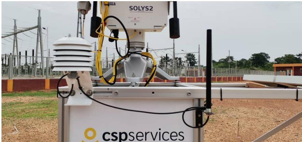
Figure 64: Capteur T/RH et antenne du modem / T/RH sensor and modem antenna.
