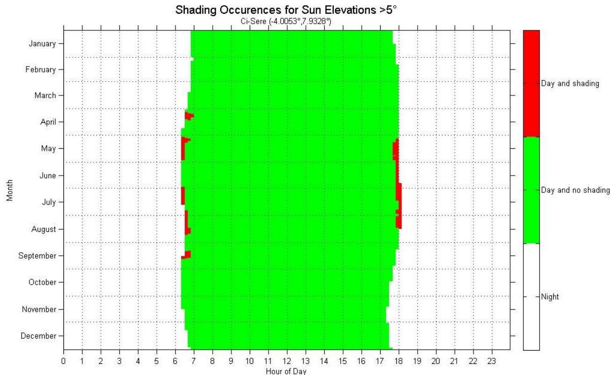
**Figure 6: Ombrage pour l'élevation du soleil > 5° / Shading occurrences for sun elevations >5°.**
