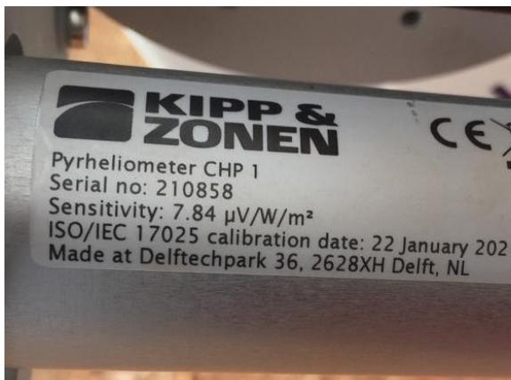
**Figure 60: Numéro de série du pyrhéliomètre / Pyrheliometer serial number.**
