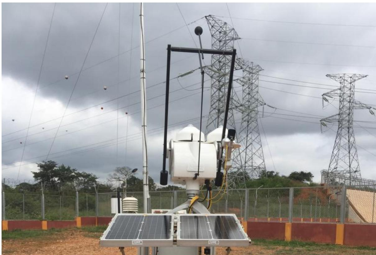
**Figure 91: Tracker solaire, capteurs et panneaux PV du système de mesure de salissure (PV-S) / Solar tracker, sensors and PV panels of soiling measurement system (PV-S).**
