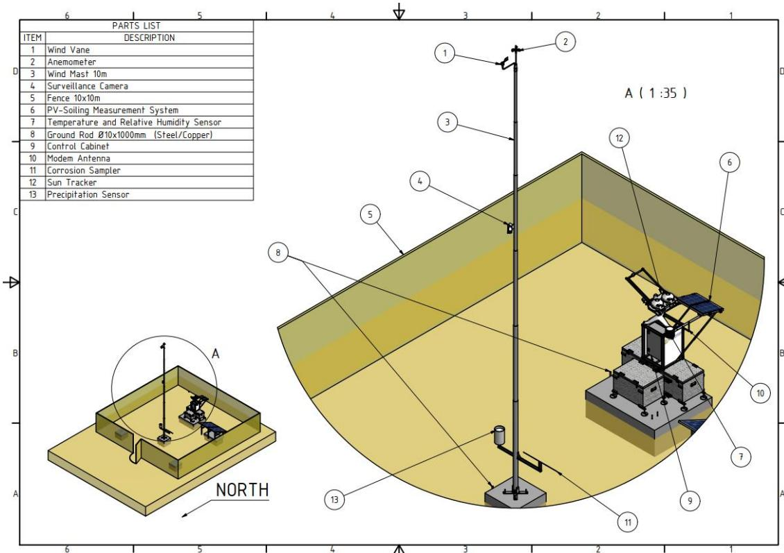
**Figure 9: Disposition de la station météorologique automatique Tier1 : détails du mât éolien de mesure et des capteurs de vent / Tier1 automatic weather station layout: wind mast and wind sensors details.**
