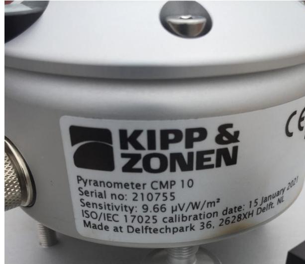
**Figure 51: Numéro de série du pyranomètre CMP10 (GHI) / CMP10 pyranometer serial number (GHI).**
