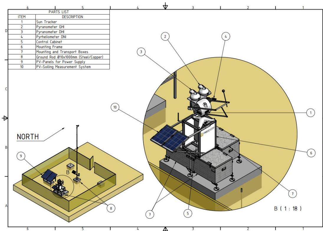
**Figure 8: Disposition de la station météorologique automatique Tier1 : Capteurs d'irradiance, système de mesure du taux de salissure PV, panneaux PV pour l'alimentation électrique / Tier1 automatic weather station layout: Irradiance sensors, PV soiling rate measurement system, PV panels for power supply.**
