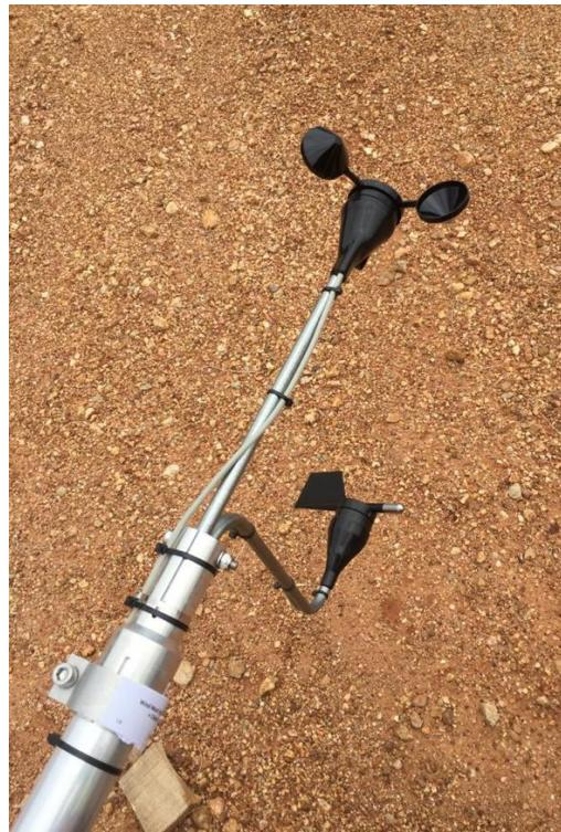
**Figure 49: Capteurs de vent installés sur le mât du vent / Wind sensors installed on wind mast.**
