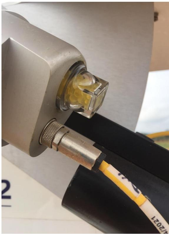
**Figure 83: Changement du dessiccat de pyrhéliomètre / Change of pyrheliometer desiccant.**
