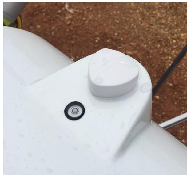
Figure 55: Mise à niveau du tracker / Tracker leveling.
