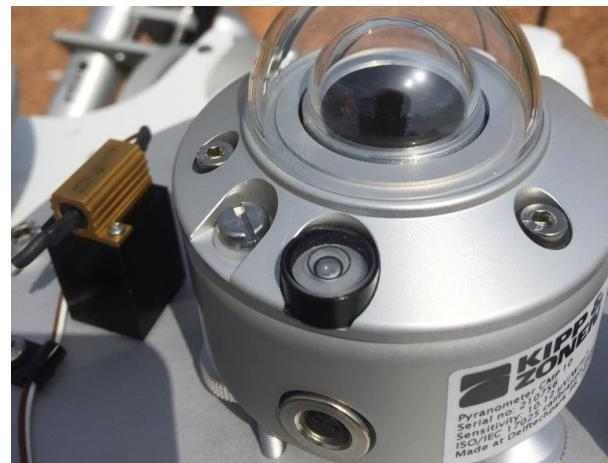
Figure 53: Mise à niveau du pyranomètre CMP10 (GHI) / CMP10 pyranometer leveling (GHI).
