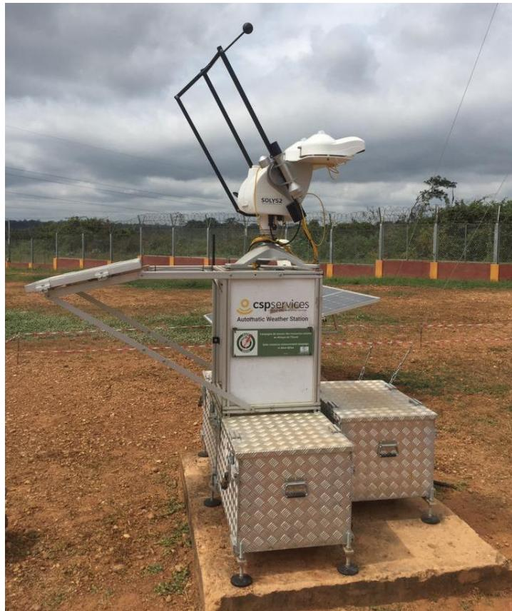
**Figure 92: Structure de montage, tracker solaire, capteurs et boîtier de contrôle / Mounting structure, solar tracker, sensors and control box.**
