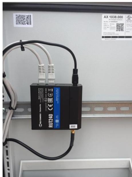
Figure 66: Routeur LTE / LTE router.
