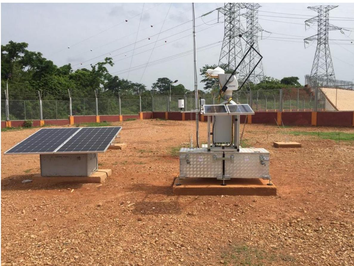
**Figure 2: Station météorologique automatique de Sérébou, Côte d'Ivoire / Automatic weather station in Sérébou, Côte d'Ivoire.**
