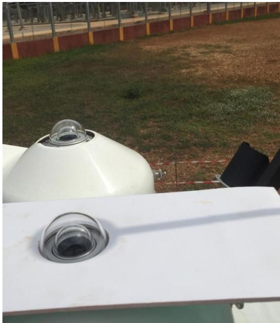
**Figure 81: Alignement de l'assemblage de l'ombrage / Shading assembly alignment.**
