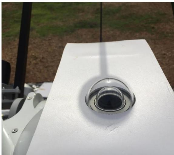
**Figure 62: Mise à niveau du dispositif d'ombrage / Shading assembly alignment.**
