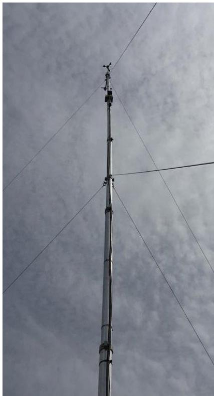
**Figure 50: Mât du vent installé capteur de direction du vent orienté vers le nord / Wind mast installed; wind direction sensor orientated to north.**
