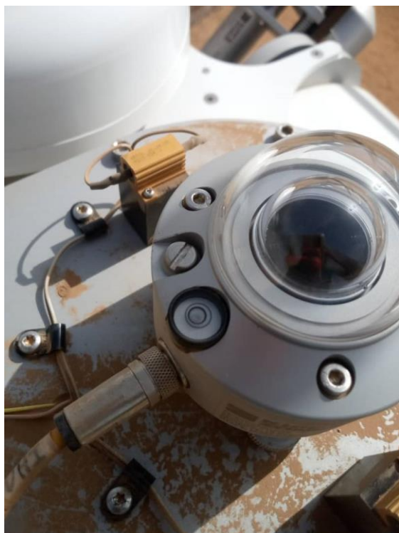
Figure 79: Mise à niveau du pyranomètre CMP10 (GHI) / CMP10 pyranometer leveling (DHI).
