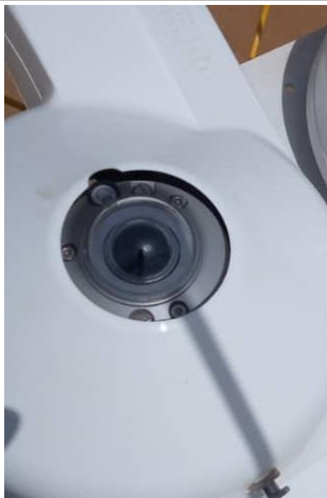
Figure 81: Alignement de l'assemblage de l'ombrage / Shading assembly alignment.
