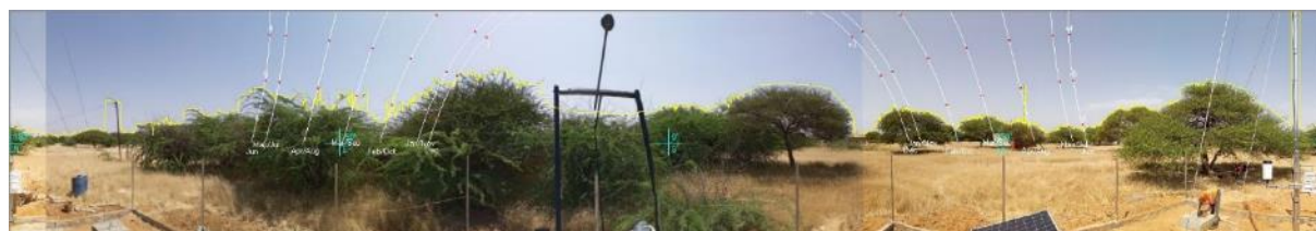
Figure 5: Ligne d'horizon du point de vue du pyromètre et course du soleil tout au long de l'année / Horizon line from the perspective of the pyranometer and sun path throughout the year.
