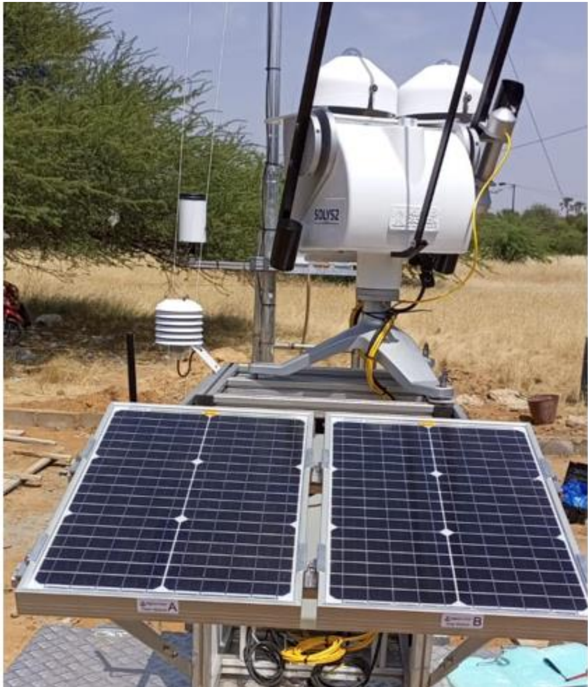
Figure 71 : Tracker solaire, capteurs et panneaux PV du système de mesure de salissure (PV-S) / Solar tracker, sensors and PV panels of soiling measurement system (PV-S).
