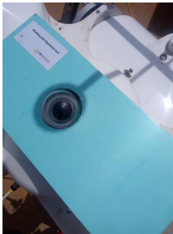
Figure 96 : Alignement de l'assemblage de l'ombrage / Shading assembly alignment.
