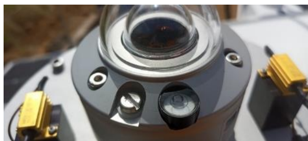
Figure 53: Mise à niveau du pyranomètre CMP10 (GHI) / CMP10 pyranometer leveling (GHI).
