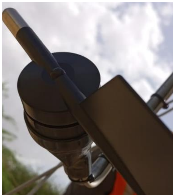
Figure 48: Marque nord du capteur de direction du vent alignée avec le cantilever de montage et la direction du nord. / Wind direction sensor north mark aligned with mounting cantilever and north direction.
