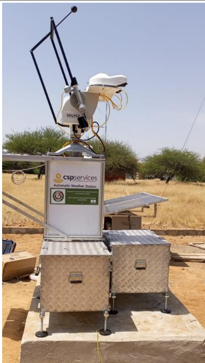
Figure 72 : Structure de montage, suiveur solaire, capteurs et boîtier de contrôle avec le logo WAPP / Mounting structure, solar tracker, sensors and control box with WAPP logo.
