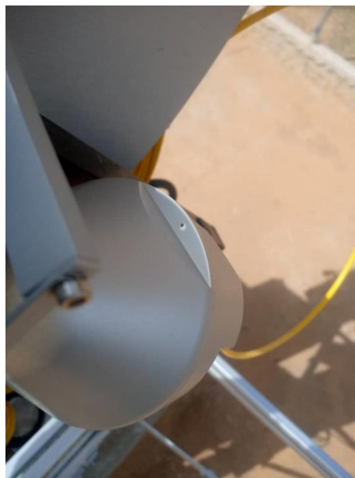
Figure 94 : Alignement du pyrhéliomètre / Pyrheliometer alignment.
