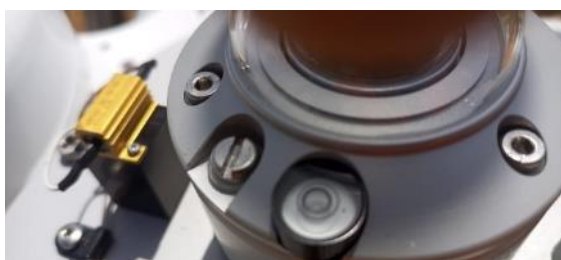
Figure 54: Mise à niveau du pyranomètre CMP10 (GHI) / CMP10 pyranometer leveling (DHI).
