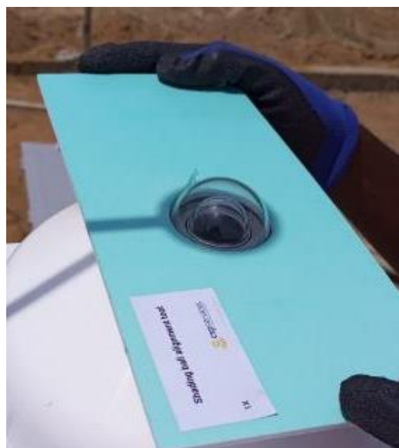
Figure 62: Mise à niveau du dispositif d'ombrage / Shading assembly alignment.
