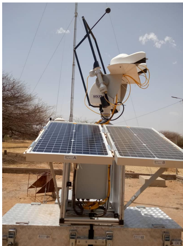
Figure 91 : Tracker solaire, capteurs et panneaux PV du système de mesure de salissure (PV-S) / Solar tracker, sensors and PV panels of soiling measurement system (PV-S).
