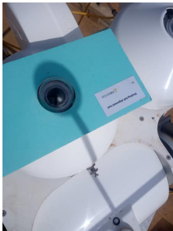
Figure 95: Alignement de l'assemblage de l'ombrage avant correction / Shading assembly alignment before correction.
