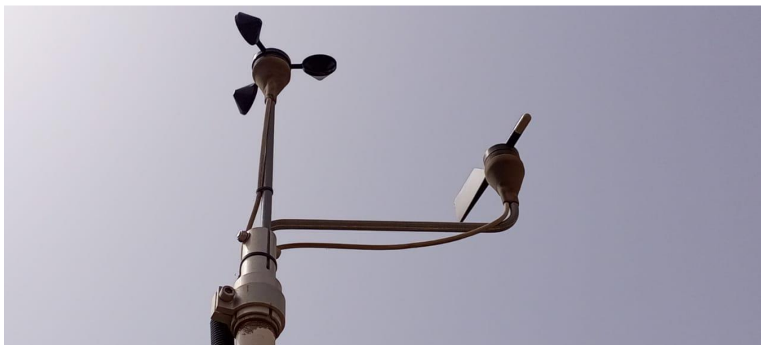
Figure 81: Capteurs de vent sur le mât de vent (3m au-dessus du sol) / Wind sensors on wind mast (3m above ground).
