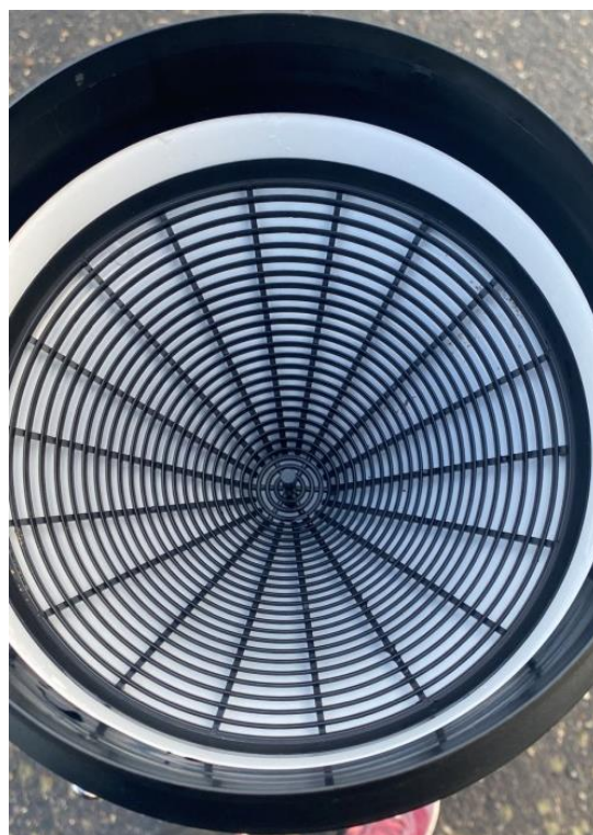
Figure 79: Capteur de pluie après le nettoyage / Rain sensor after cleaning.
