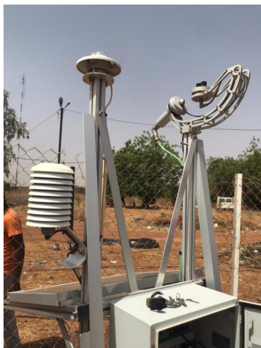
Figure 47: Capteurs d'irradiance RSI et CMP10 sur la structure de montage / RSI and CMP10 irradiance sensors on mounting structure.
