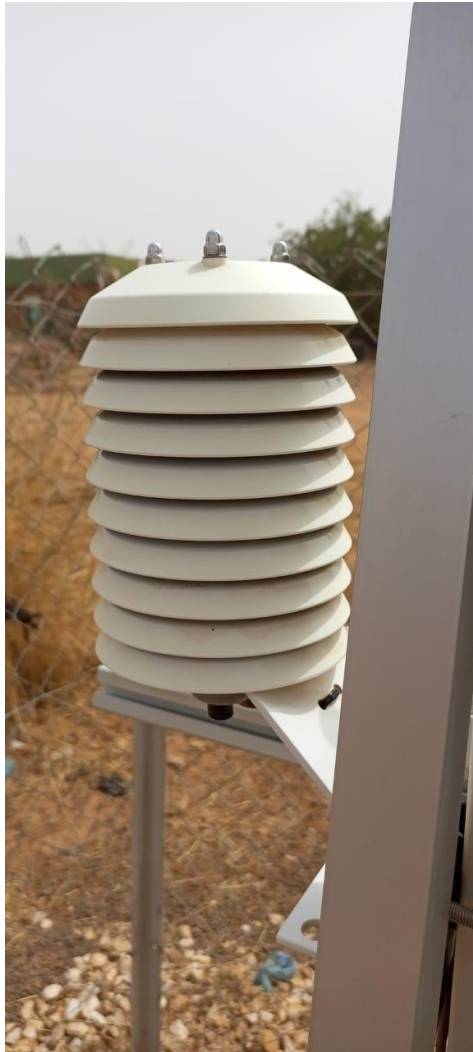
Figure 73 : Capteur de température et d'humidité dans le boîtier (protection contre les radiations) / Temperature and humidity sensor in housing (radiation shield).
