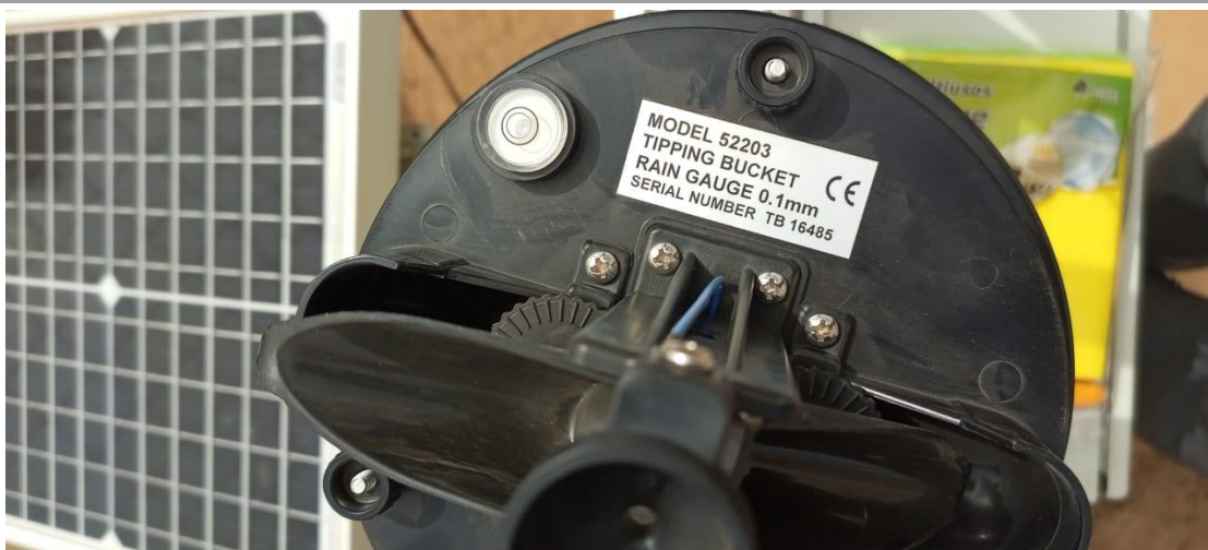
Figure 80: Mise à niveau du capteur de pluie / Rain sensor levelling.
