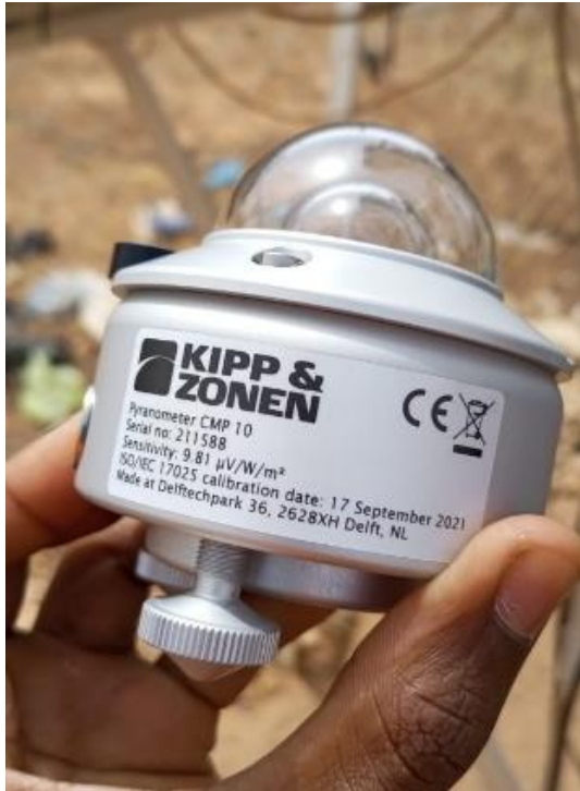
Figure 69: Pyranomètre CMP10 calibré / Calibrated CMP10 pyranometer.
