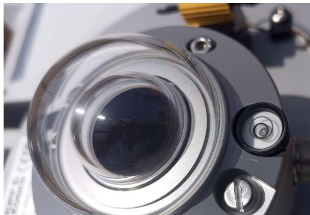
Figure 18: Mise à niveau du pyranomètre CMP10 (GHI) / CMP10 pyranometer leveling (GHI)
