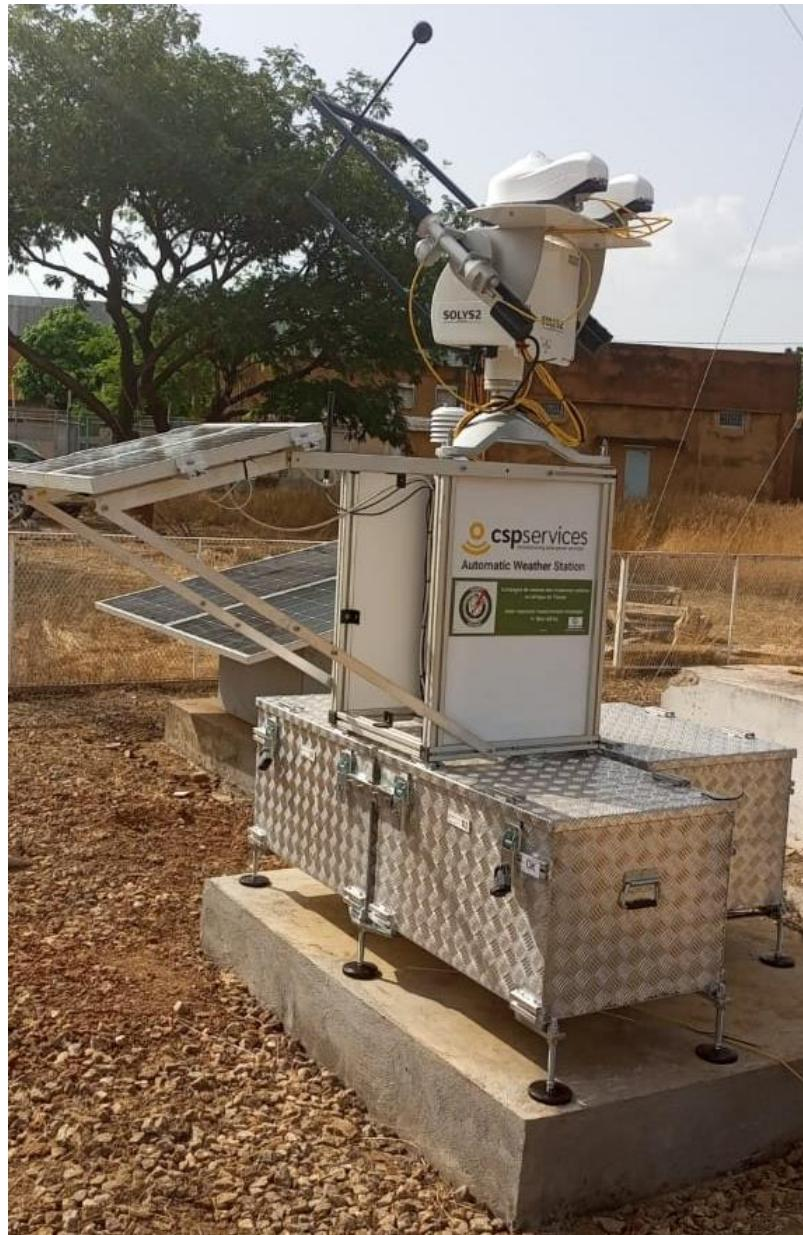
**Figure 37 : Structure de montage, suiveur solaire, capteurs et boîtier de contrôle avec le logo WAPP / Mounting structure, solar tracker, sensors and control box with WAPP logo.**
