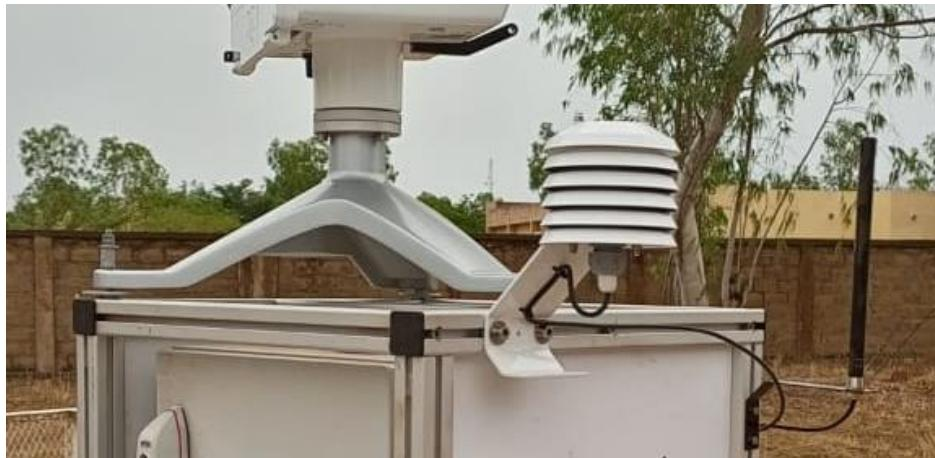
**Figure 29: Capteur T/RH et antenne du modem / T/RH sensor and modem antenna**
