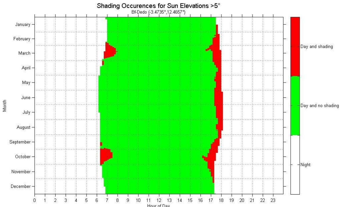
**Figure 4: Ombrage pour l'élevation du soleil > 5° / Shading occurrences for sun elevations >5°.**
