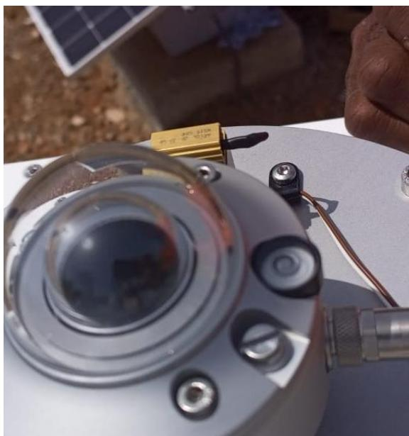
Figure 19: Mise à niveau du pyranomètre CMP10 (GHI) / CMP10 pyranometer leveling (DHI)
