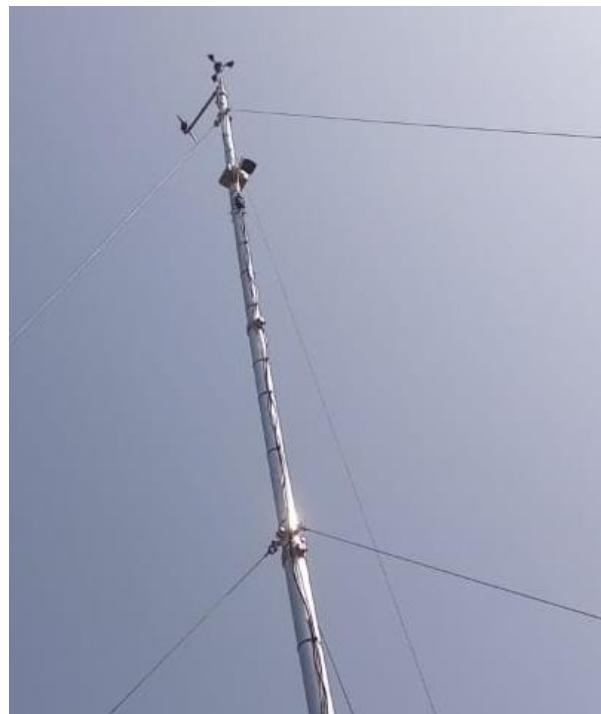
**Figure 14: Capteurs de vent installés sur le mât du vent / Wind sensors installed on wind mast**
