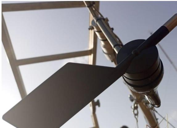
**Figure 13: Marque nord du capteur de direction du vent alignée avec le cantilever de montage et la direction du nord. / Wind direction sensor north mark aligned with mounting cantilever and north direction**
