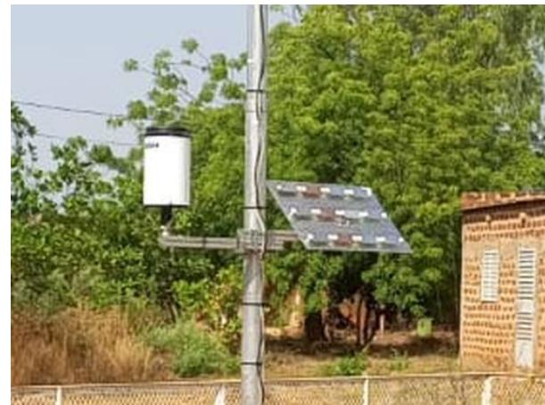
**Figure 24: Capteur de pluie et échantillonneur de corrosion / Rain sensor and corrosion sampler**
