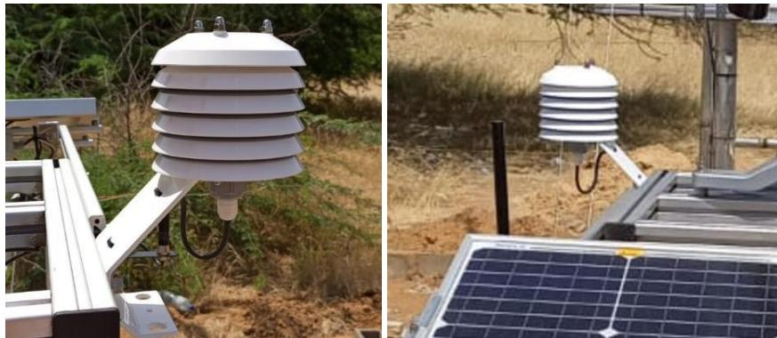
**Figure 29: Capteur T/RH et antenne du modem / T/RH sensor and modem antenna**
