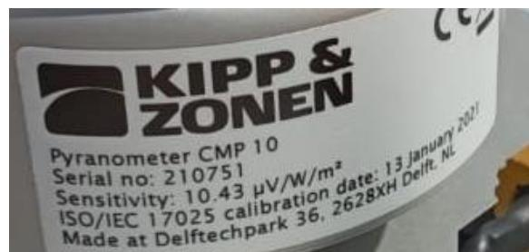
**Figure 16: Numéro de série du pyranomètre CMP10 (GHI) / CMP10 pyranometer serial number (GHI)**
