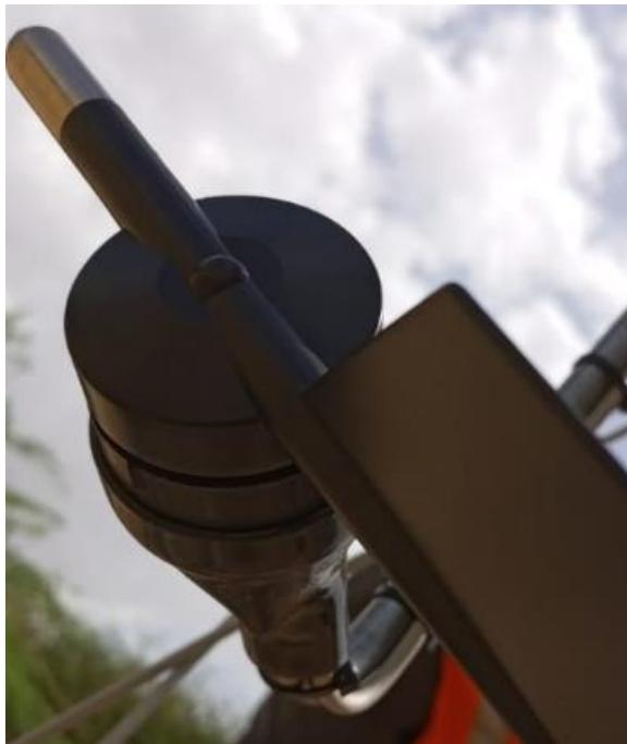
**Figure 13: Marque nord du capteur de direction du vent alignée avec le cantilever de montage et la direction du nord. / Wind direction sensor north mark aligned with mounting cantilever and north direction**
