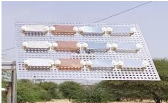
**Figure 34: Echantillonneur de corrosion / Corrosion sampler.**
