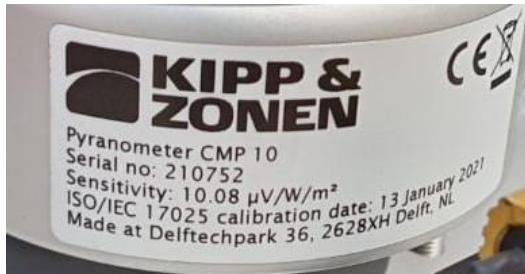
Figure 17: Numéro de série du pyranomètre CMP10 (DHI) / CMP10 pyranometer serial number (DHI)
