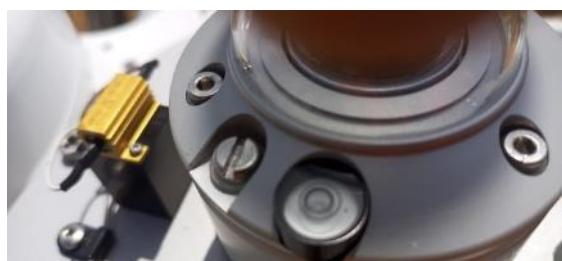
Figure 19: Mise à niveau du pyranomètre CMP10 (GHI) / CMP10 pyranometer leveling (DHI)
