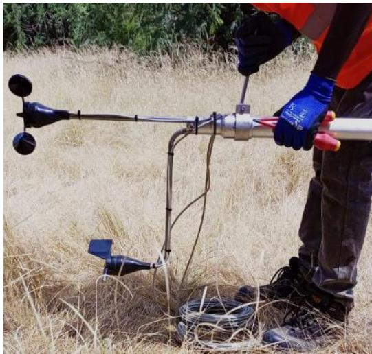
**Figure 11: Préparatifs du mât du vent / Wind mast preparations**
