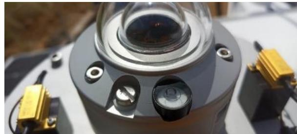
Figure 18: Mise à niveau du pyranomètre CMP10 (GHI) / CMP10 pyranometer leveling (GHI)
