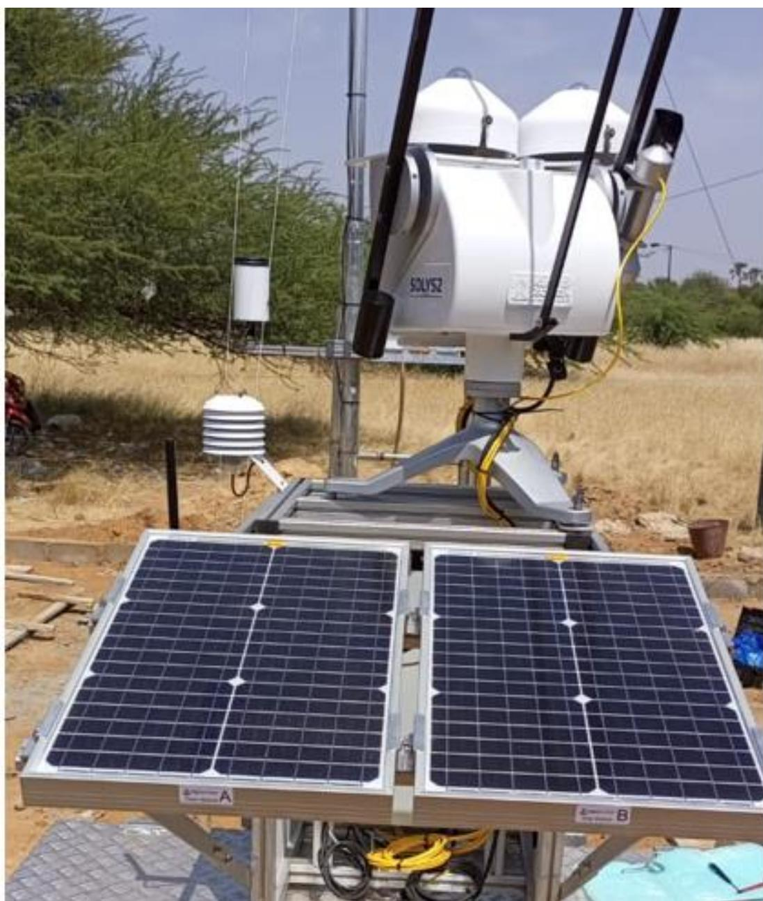
**Figure 36 : Tracker solaire, capteurs et panneaux PV du système de mesure de salissure (PV-S) / Solar tracker, sensors and PV panels of soiling measurement system (PV-S).**
