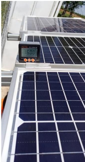
**Figure 54: Alignement système mesure taux d'encrassement / Alignment soiling rate measurement system.**
