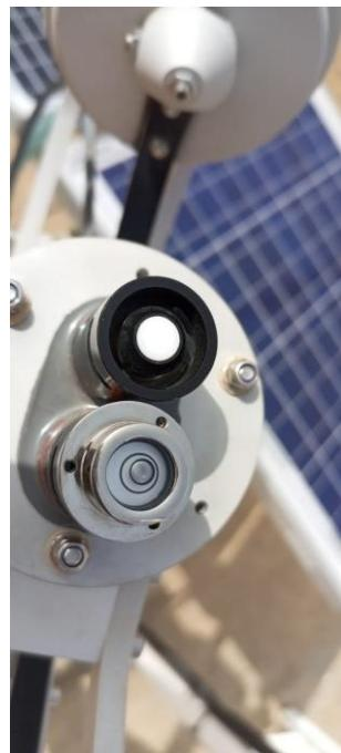
**Figure 65:** Nivellement pyranomètre RSI nouveau / New RSI pyranometer horizontal leveling.
