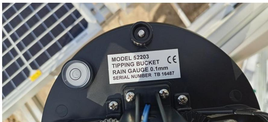
**Figure 49: Nivellement et numéro série pluviomètre / Leveling and serial number rain gauge.**
