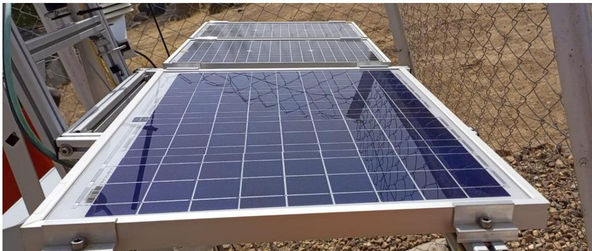
**Figure 73:** Module PV d'alimentation (avant-plan) et modules de mesure de salissure (arrière-plan) / PV supply module (foreground) and soiling measurement modules (background).
