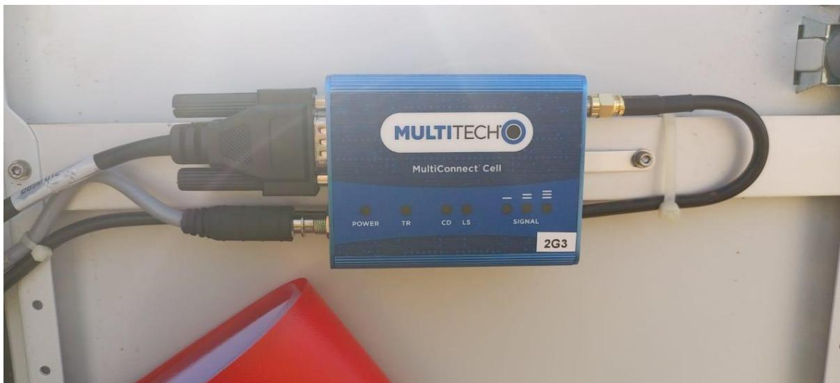
**Figure 11: Modem GSM pour la transmission des données de mesure / GSM Modem for measurement data transmission**
