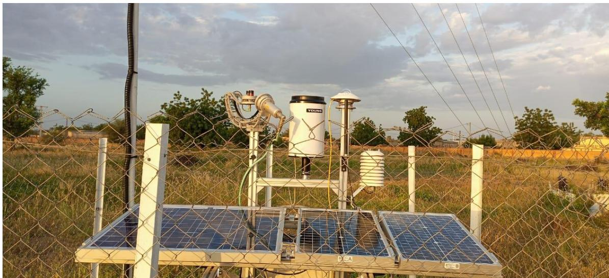
**Figure 51: Station de mesure après la mise à niveau des capteurs / Measurement station after sensor upgrade.**
