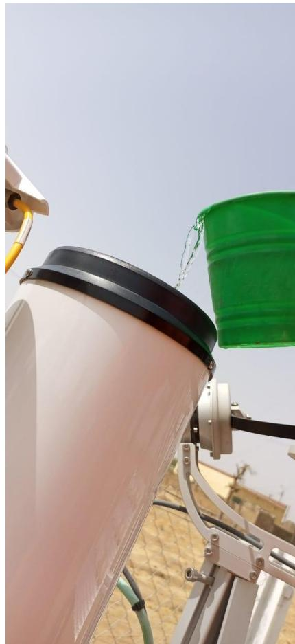
**Figure 71: Test de fonctionnement pluviomètre / Functionality test rain gauge.**
