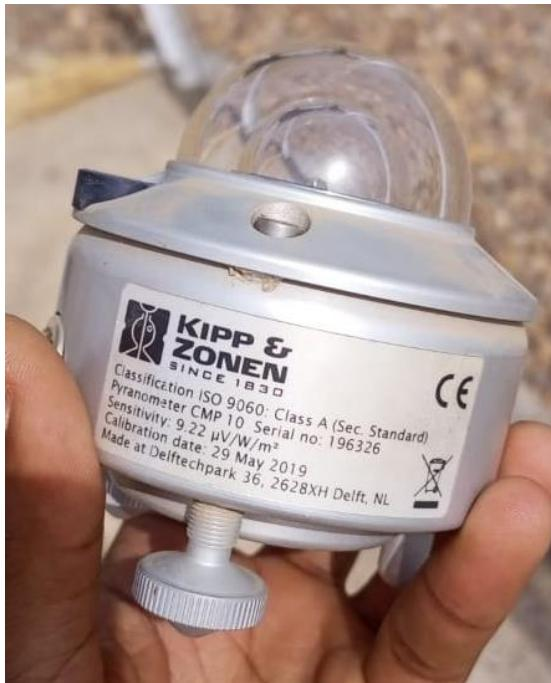
**Figure 66: Pyranomètre CMP10 ancien / Old CMP10 pyranometer.**
