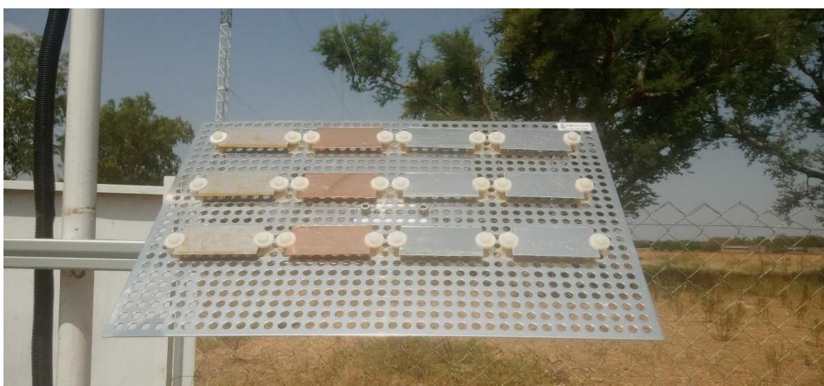
**Figure 53: Échantilleur de corrosion / Corrosion sampler**
