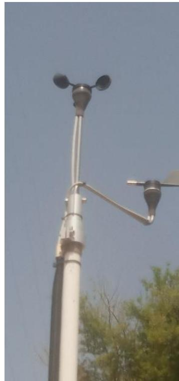
**Figure 59: Capteurs vitesse et direction de vent / Wind speed and direction sensors.**
