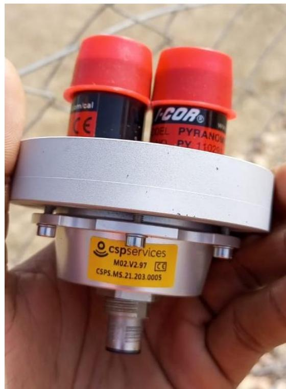
**Figure 63:** Pyranomètre RSI nouveau / New RSI pyranometer.
