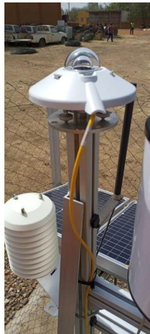
**Figure 69: Pyranomètre CMP nouveau installé / New CMP10 pyranometer installed.**
