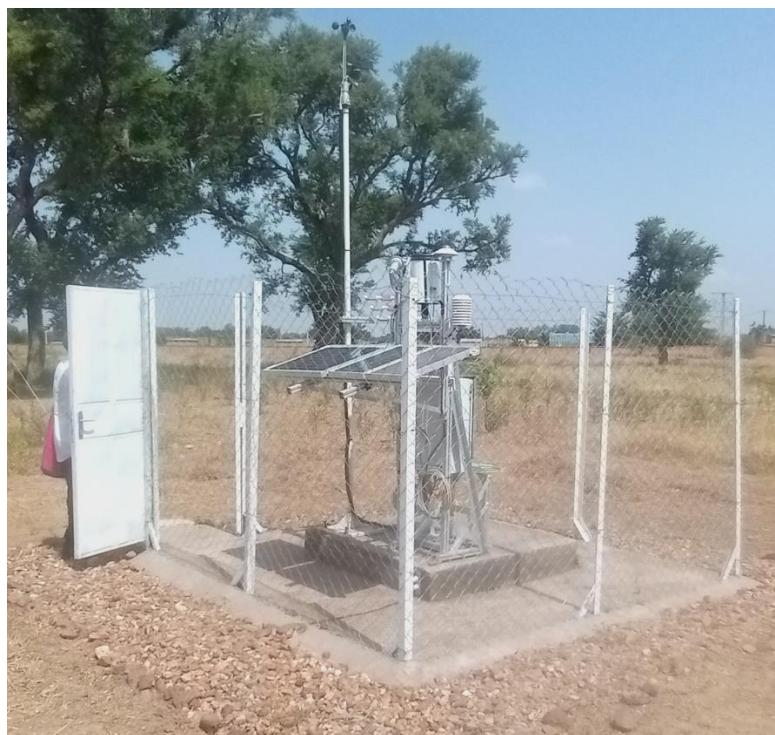
**Figure 2: Station météorologique automatique de Koupéla, Burkina Faso / Automatic weather station in Koupéla, Burkina Faso.**
