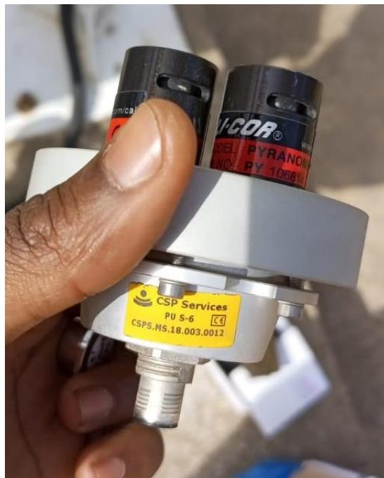
**Figure 64:** Pyranomètre RSI ancien / Old RSI pyranometer.
