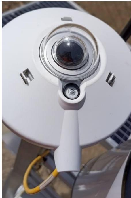
**Figure 68 : Nivellement pyranomètre CMP10 nouveau / New CMP10 pyranometer horizontal leveling.**
