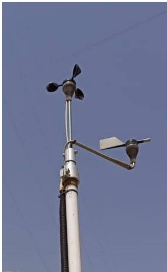
**Figure 74:** Capteurs de vent sur le mât de vent (3m au-dessus du sol) / Wind sensors on wind mast (3m above ground).
