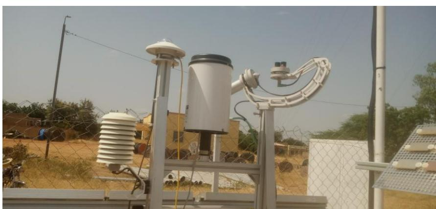
**Figure 50: Installation du capteur de pluie sur la structure de montage / Rain sensor installation on mounting structure.**
