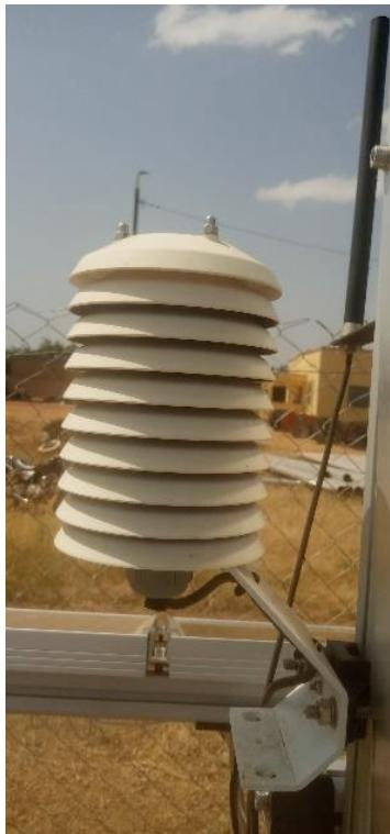
**Figure 58: Boucle d'irradiation thermo-hygromètre / Radiation shield of thermo-hygrometer**
