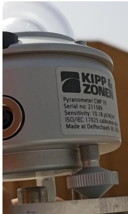
**Figure 67 : Pyranomètre CMP10 nouveau / New CMP10 pyranometer.**
