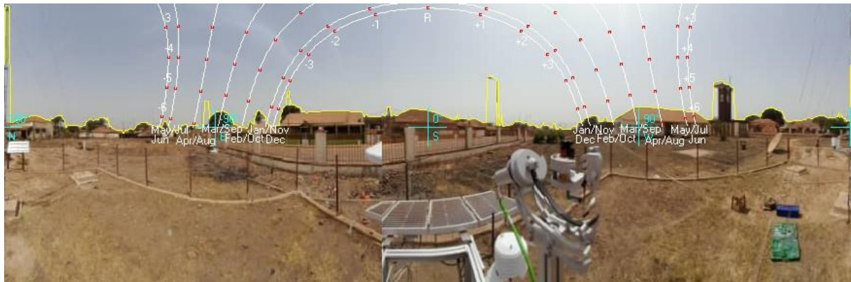
Figure 3: Ligne d'horizon du point de vue du pyranomètre et course du soleil tout au long de l'année / Horizon line from the perspective of the pyranometer and sun path throughout the year.
