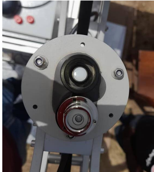
Figure 22 : Mise à niveau du PU / PU unit leveling
