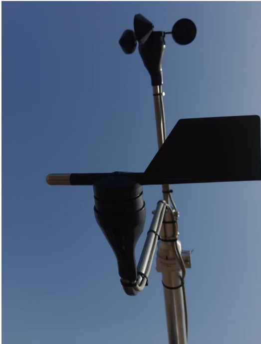
Figure 13: Marque nord du capteur de direction du vent alignée avec le cantilever de montage et la direction du nord. / Wind direction sensor north mark aligned with mounting cantilever and north direction
