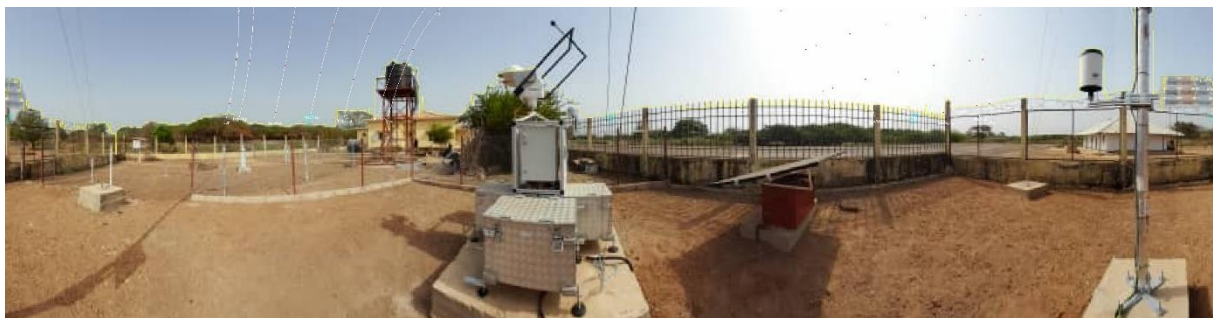
Figure 5: Ligne d'horizon du point de vue du pyromètre et course du soleil tout au long de l'année / Horizon line from the perspective of the pyranometer and sun path throughout the year.
