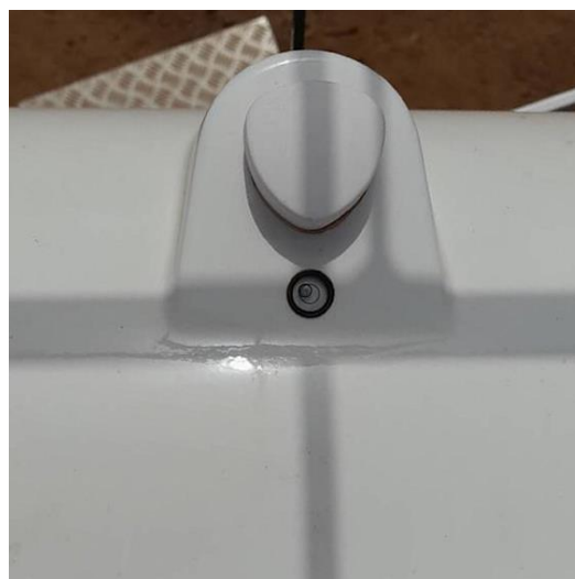
Figure 55: Mise à niveau du tracker / Tracker leveling.
