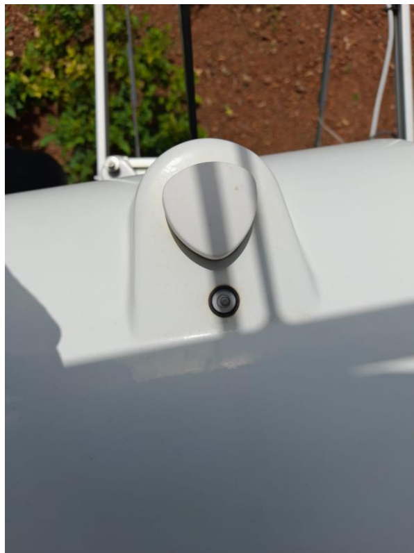
Figure 80: Mise à niveau du tracker / Tracker leveling.
