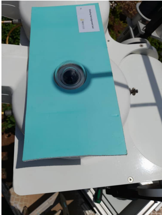
Figure 81: Alignement de l'assemblage de l'ombrage / Shading assembly alignment.
