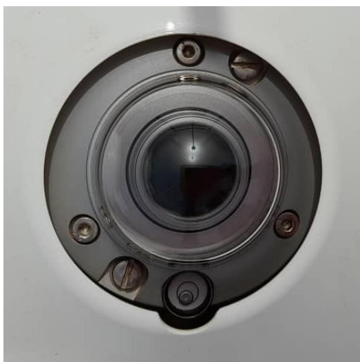
Figure 54: Mise à niveau du pyromètre CMP10 (DHI) / CMP10 pyranometer leveling (DHI).
