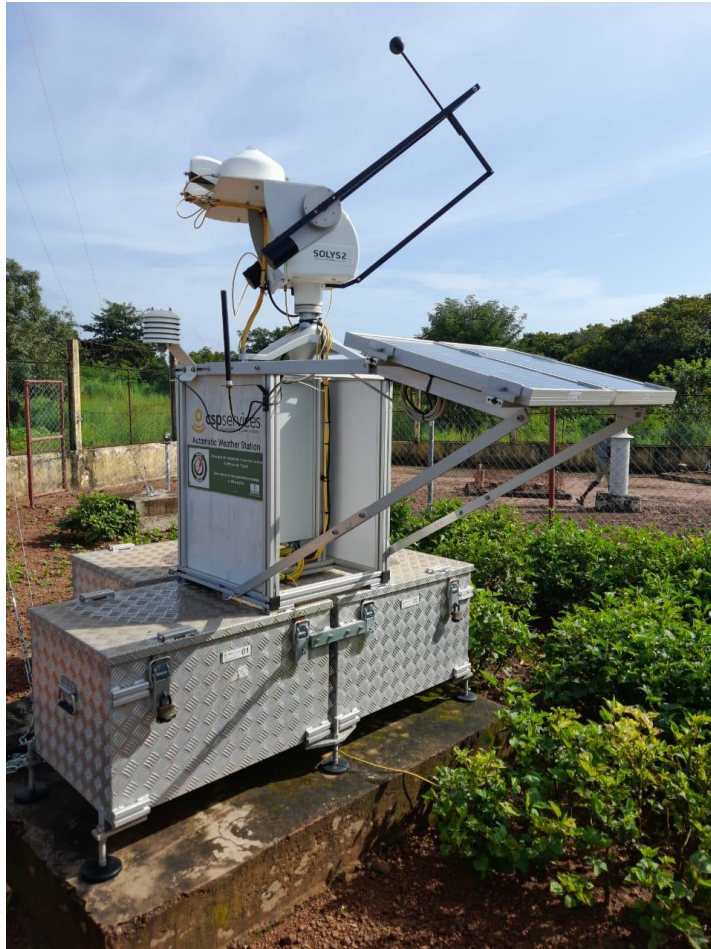
Figure 92: Structure de montage, tracker solaire, capteurs et boîtier de contrôle / Mounting structure, solar tracker, sensors and control box.
