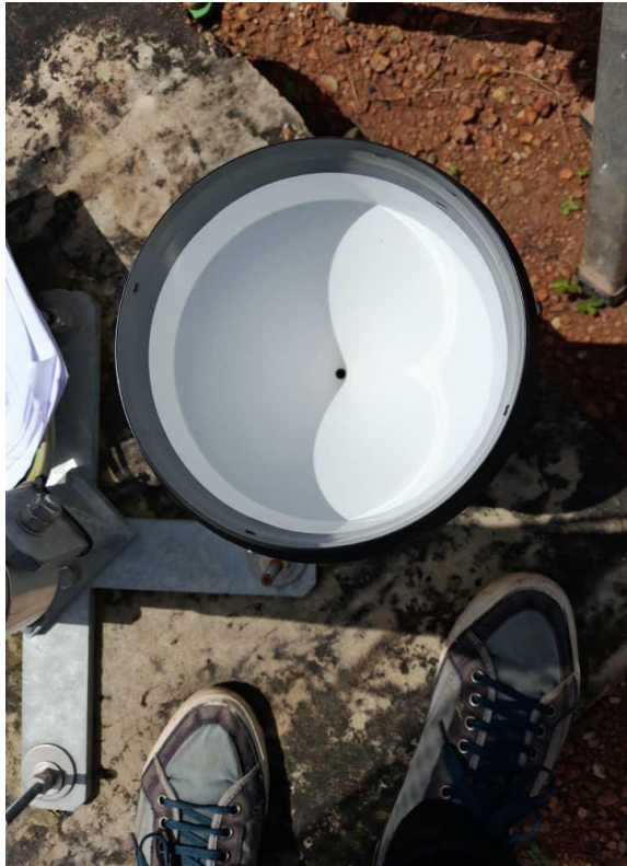
Figure 85: Nettoyage du capteur de pluie / Rain sensor cleaning.
