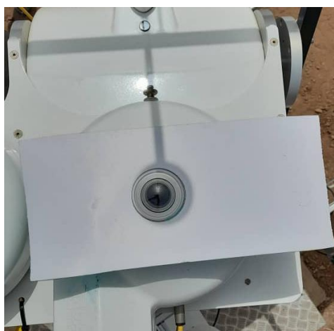
Figure 62: Mise à niveau du dispositif d'ombrage / Shading assembly alignment.
