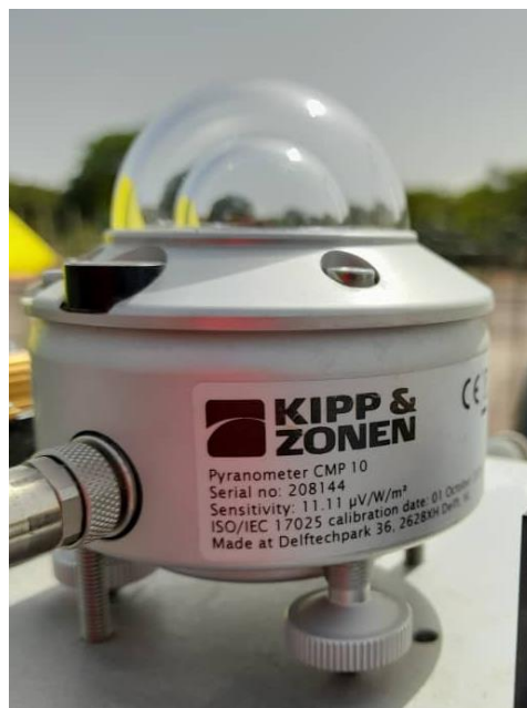
Figure 51: Numéro de série du pyranomètre CMP10 (GHI) / CMP10 pyranometer serial number (GHI).
