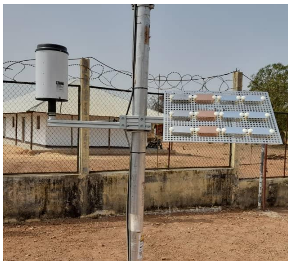
Figure 59: Capteur de pluie et échantillonneur de corrosion / Rain sensor and corrosion sampler.
