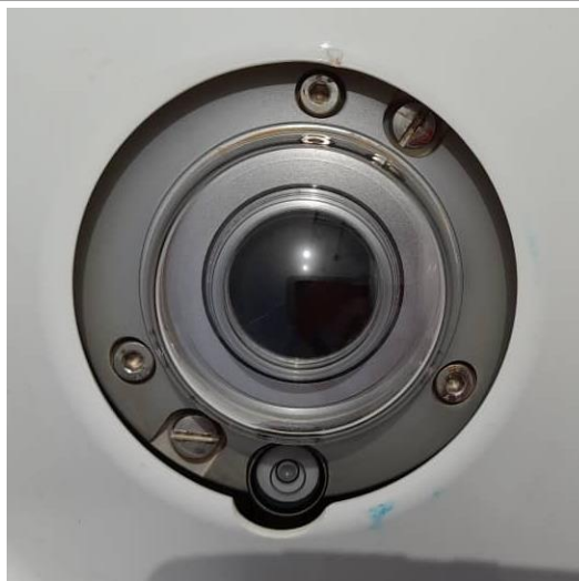
Figure 53: Mise à niveau du pyromètre CMP10 (GHI) / CMP10 pyranometer leveling (GHI).
