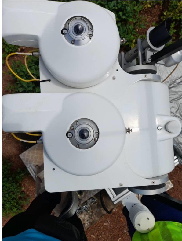
Figure 78: Pyranomètres et ventilations sur le tracker solaire / Pyranometers and ventilation units on solar tracker.
