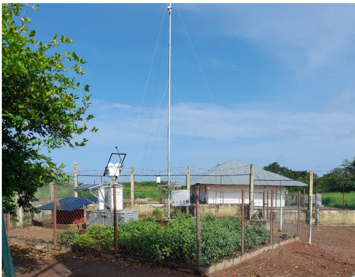
Figure 2: Station météorologique automatique de Gabu, Guinée-Bissau / Automatic weather station in Gabu, Guinea-Bissau.
