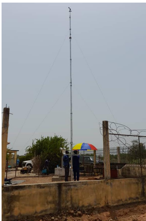
Figure 50: Mât du vent installé capteur de direction du vent orienté vers le nord / Wind mast erected; wind direction sensor orientated to north.
