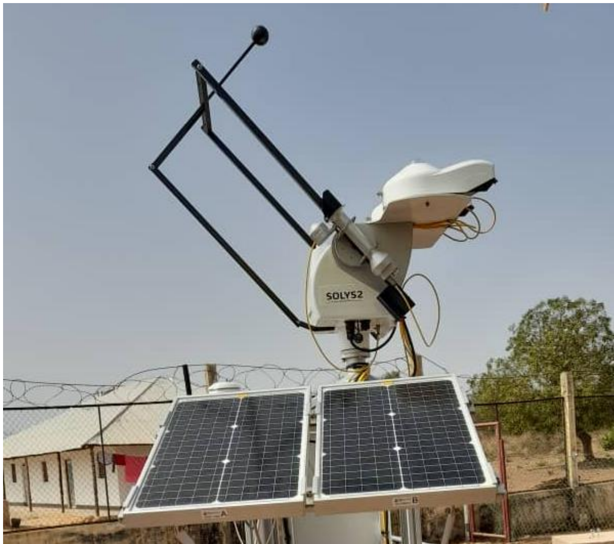
Figure 71 : Tracker solaire, capteurs et panneaux PV du système de mesure de salissure (PV-S) / Solar tracker, sensors and PV panels of soiling measurement system (PV-S).
