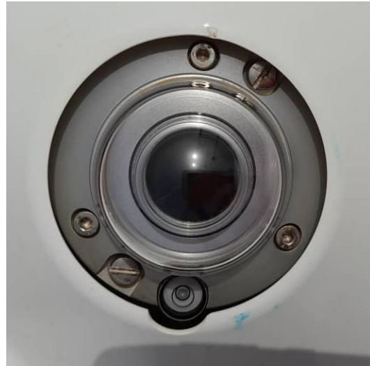
Figure 18: Mise à niveau du pyromètre CMP10 (GHI) / CMP10 pyranometer leveling (GHI)
