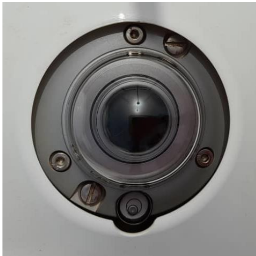
Figure 19: Mise à niveau du pyromètre CMP10 (DHI) / CMP10 pyranometer leveling (DHI)
