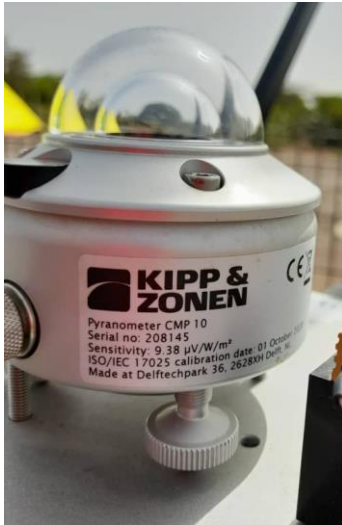
Figure 17: Numéro de série du pyromètre CMP10 (DHI) / CMP10 pyranometer serial number (DHI)
