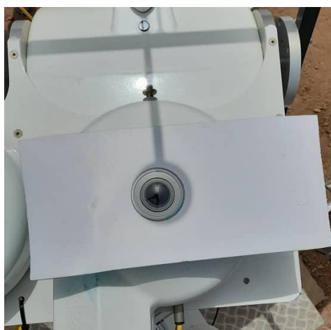
Figure 27: Mise à niveau du dispositif d'ombrage / Shading assembly alignment
