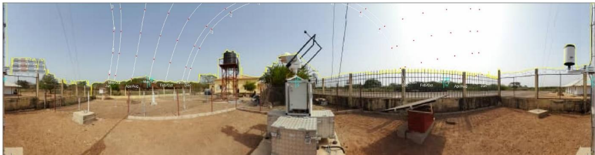
Figure 3: Ligne d'horizon du point de vue du pyranomètre et course du soleil tout au long de l'année / Horizon line from the perspective of the pyranometer and sun path throughout the year.
