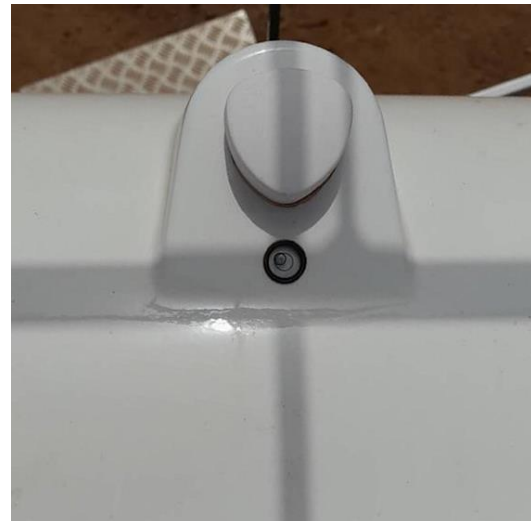
Figure 20: Mise à niveau du tracker / Tracker leveling
