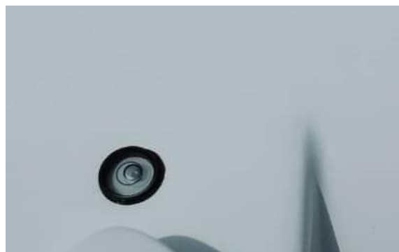
Figure 55: Mise à niveau du tracker / Tracker leveling.
