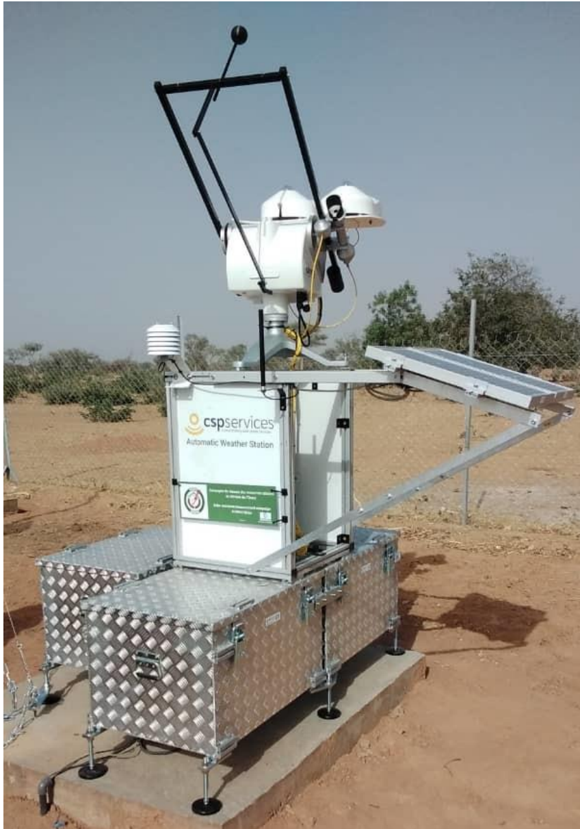
Figure 72 : Structure de montage, suiveur solaire, capteurs et boîtier de contrôle avec le logo WAPP / Mounting structure, solar tracker, sensors and control box with WAPP logo.
