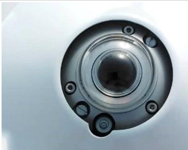
Figure 53: Mise à niveau du pyromètre CMP10 (GHI) / CMP10 pyranometer leveling (GHI).
