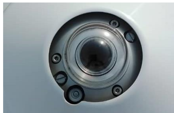
Figure 54: Mise à niveau du pyromètre CMP10 (GHI) / CMP10 pyranometer leveling (DHI).
