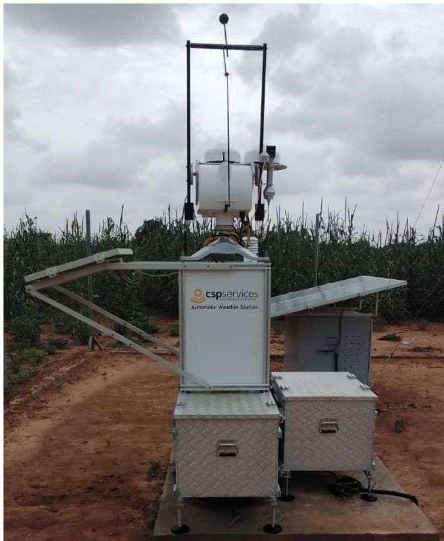
Figure 90 : Structure de montage, tracker solaire, capteurs et boîtier de contrôle / Mounting structure, solar tracker, sensors and control box.
