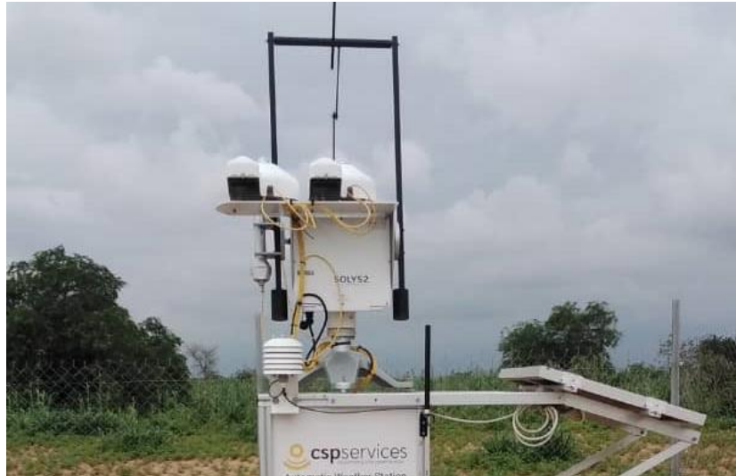
Figure 89 : Tracker solaire, capteurs et panneaux PV du système de mesure de salissure (PV-S) / Solar tracker, sensors and PV panels of soiling measurement system (PV-S).
