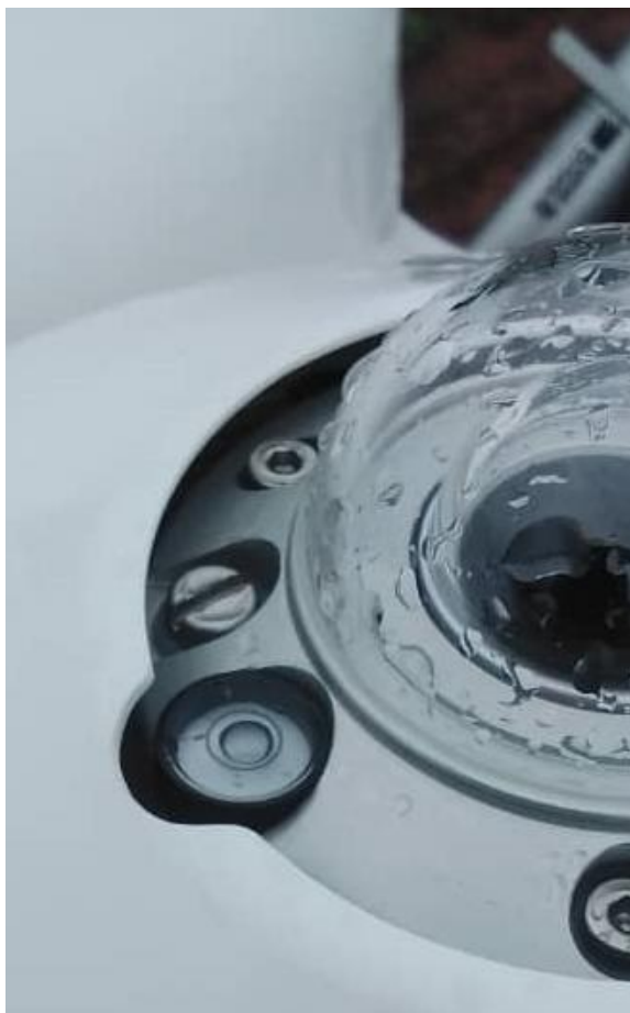
Figure 79: Mise à niveau du pyranomètre CMP10 (GHI) / CMP10 pyranometer leveling (DHI).
