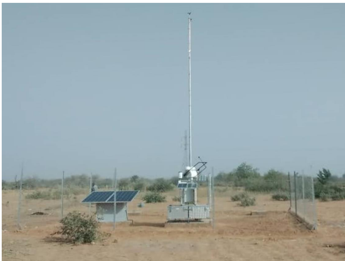
Figure 2: Station météorologique automatique de Zabori, Niger / Automatic weather station in Zabori, Niger.
