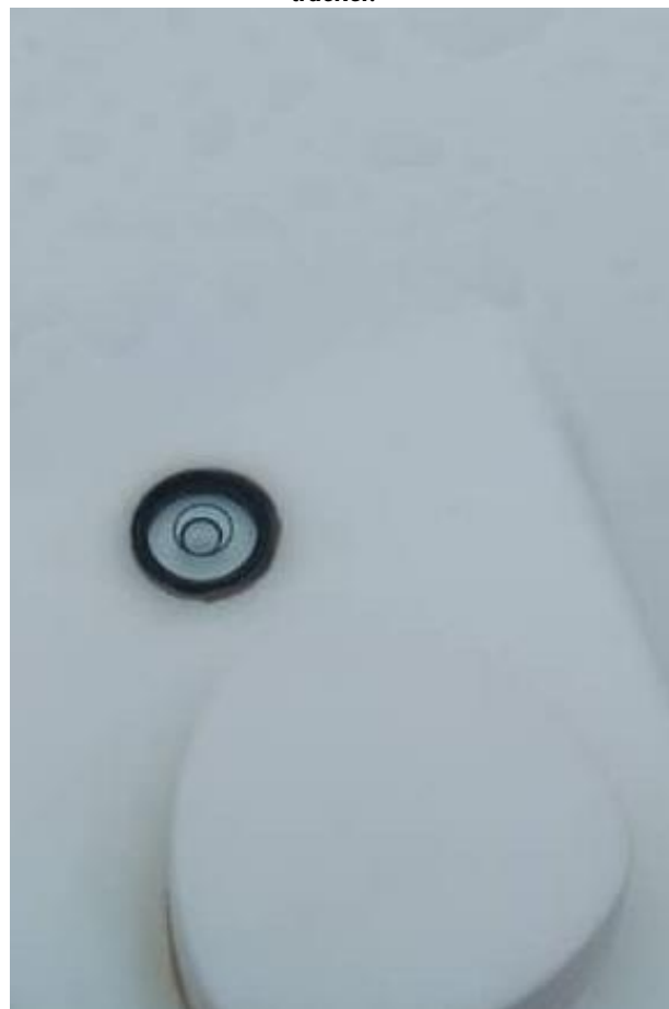
Figure 80: Mise à niveau du tracker / Tracker leveling.
