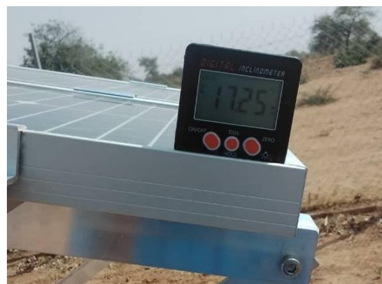
Figure 68: Structure de support PV-S avec un angle d'inclinaison de 17° vers le sud / PV-S support structure with 17° tilt angle towards south.
