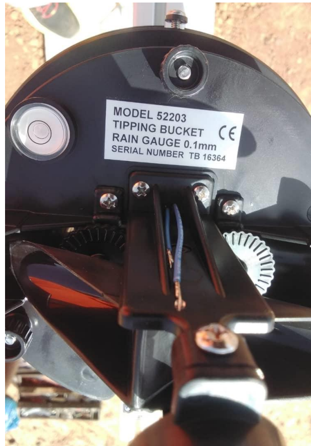
Figure 26: Nivellement du capteur de pluie / Rain sensor levelling
