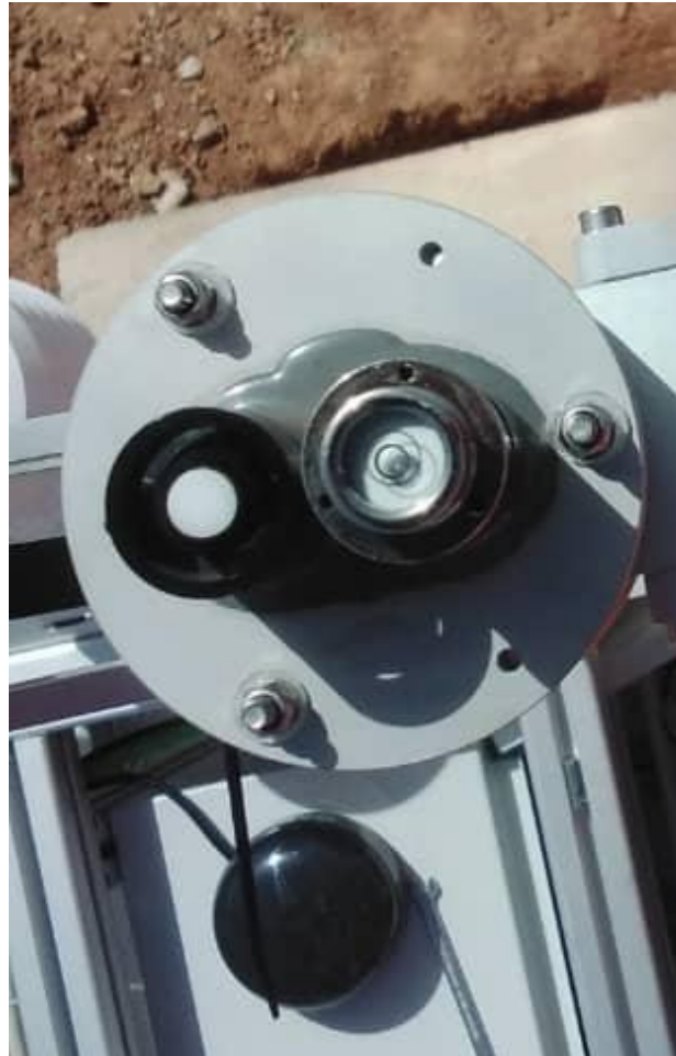
Figure 22 : Mise à niveau du PU / PU unit leveling
