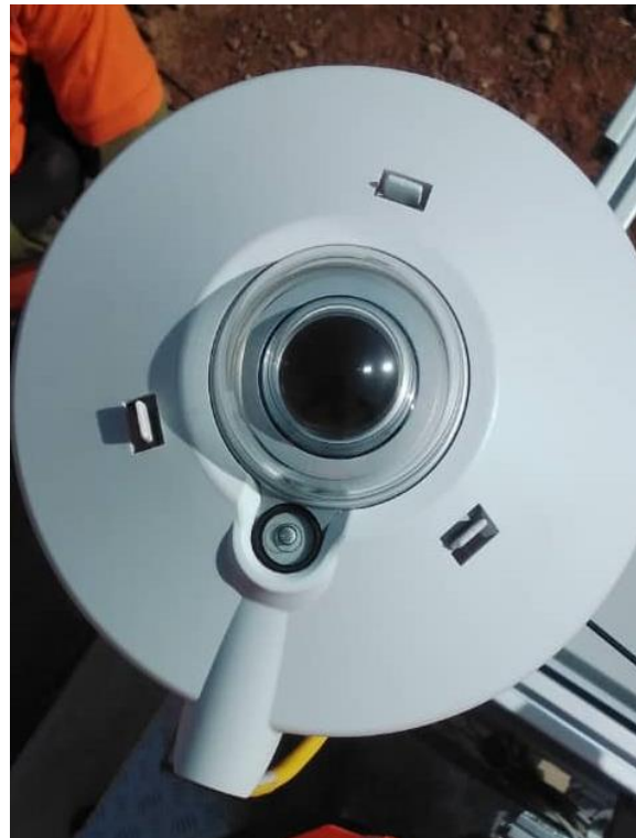
Figure 18: Mise à niveau du pyromètre CMP10 (GHI) / CMP10 pyranometer leveling (GHI)
