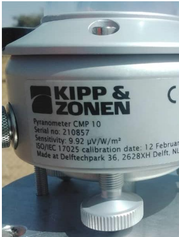
Figure 53: Numéro de série du pyromètre CMP10 (GHI) / CMP10 pyranometer serial number (GHI).
