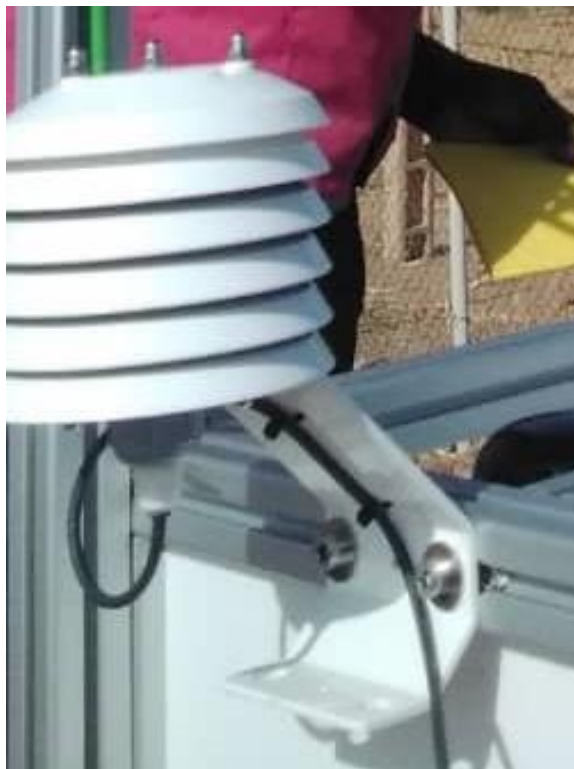
Figure 63: Capteur T/RH / T/RH sensor.
