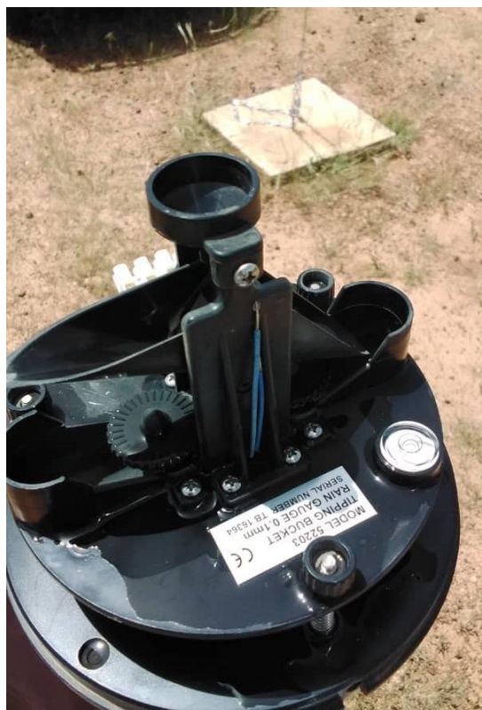
Figure 95: Nettoyage du capteur de pluie / Rain sensor cleaning.
