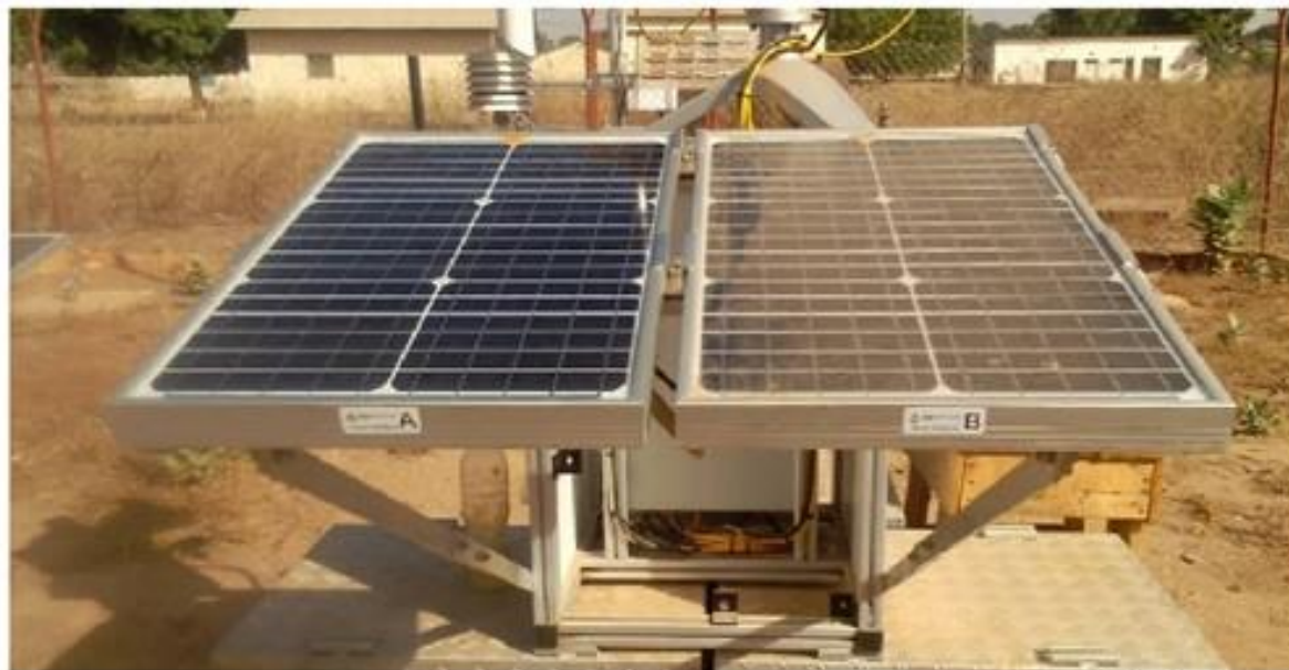
Figure 32: Système PV-salissure avec le panneau de référence propre (modA) et le panneau de mesure (modB). Le panneau de référence est maintenu propre par un nettoyage régulier effectué par le personnel de maintenance local, tandis que le panneau de mesure peut accumuler des salissures au fil du temps. / PV-soiling system with the clean reference panel (modA) and the measurement panel (modB). The reference panel is kept clean by regular cleaning by the local maintenance staff whereas the measurement panel is allowed to accumulate soiling over time.
