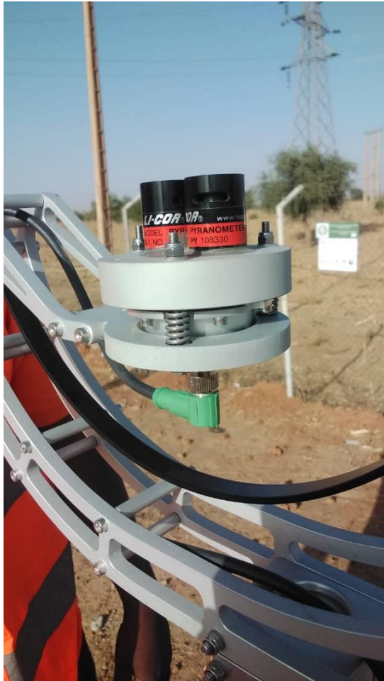
Figure 57 : Unité PU avec Licor installé / PU Unit with Licor installed.
