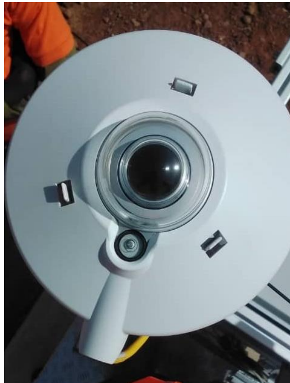
Figure 54: Mise à niveau du pyromètre CMP10 (GHI) / CMP10 pyranometer leveling (GHI).
