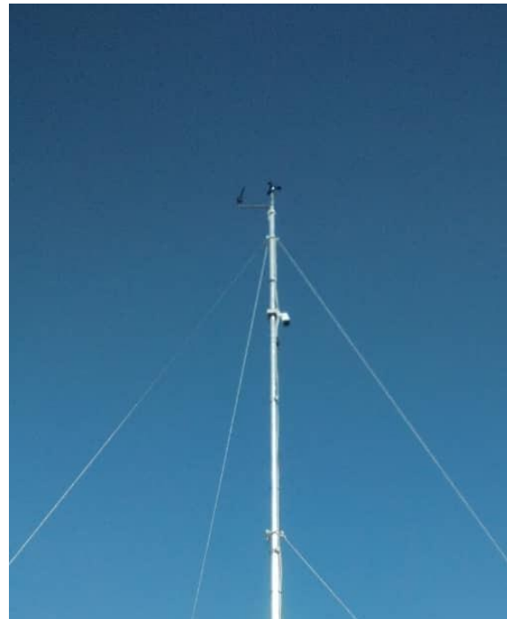
Figure 50: Capteurs de vent installés sur le mât du vent / Wind sensors installed on wind mast.
