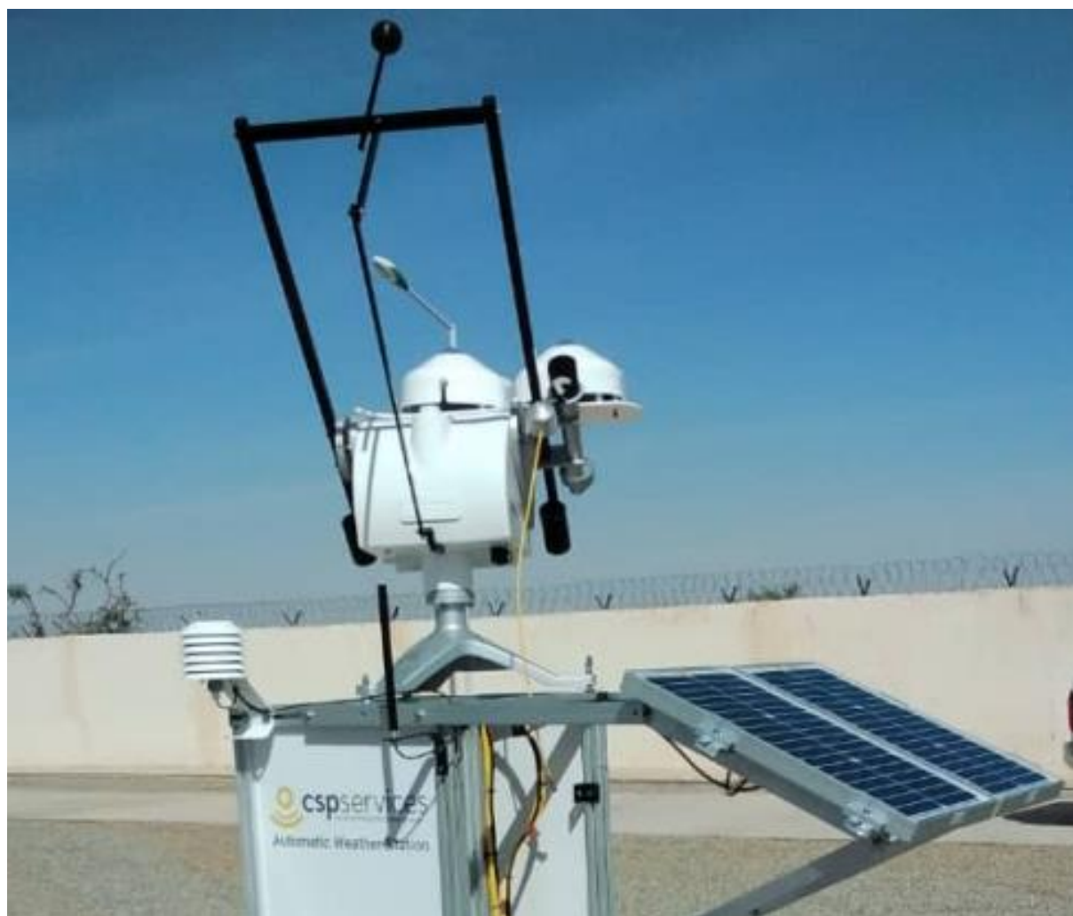
Figure 36 : Tracker solaire, capteurs et panneaux PV du système de mesure de salissure (PV-S) / Solar tracker, sensors and PV panels of soiling measurement system (PV-S).
