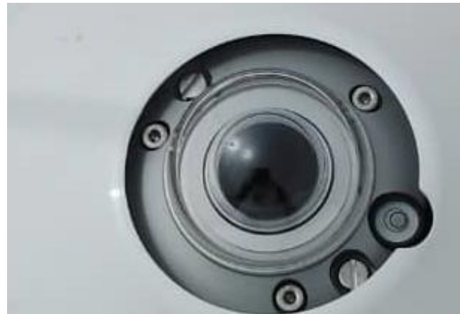
Figure 18: Mise à niveau du pyranomètre CMP10 (GHI) / CMP10 pyranometer leveling (GHI)
