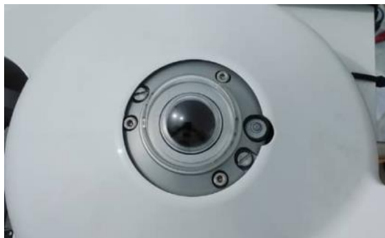
Figure 19: Mise à niveau du pyranomètre CMP10 (GHI) / CMP10 pyranometer leveling (DHI)
