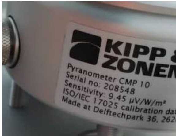
Figure 17: Numéro de série du pyranomètre CMP10 (DHI) / CMP10 pyranometer serial number (DHI)
