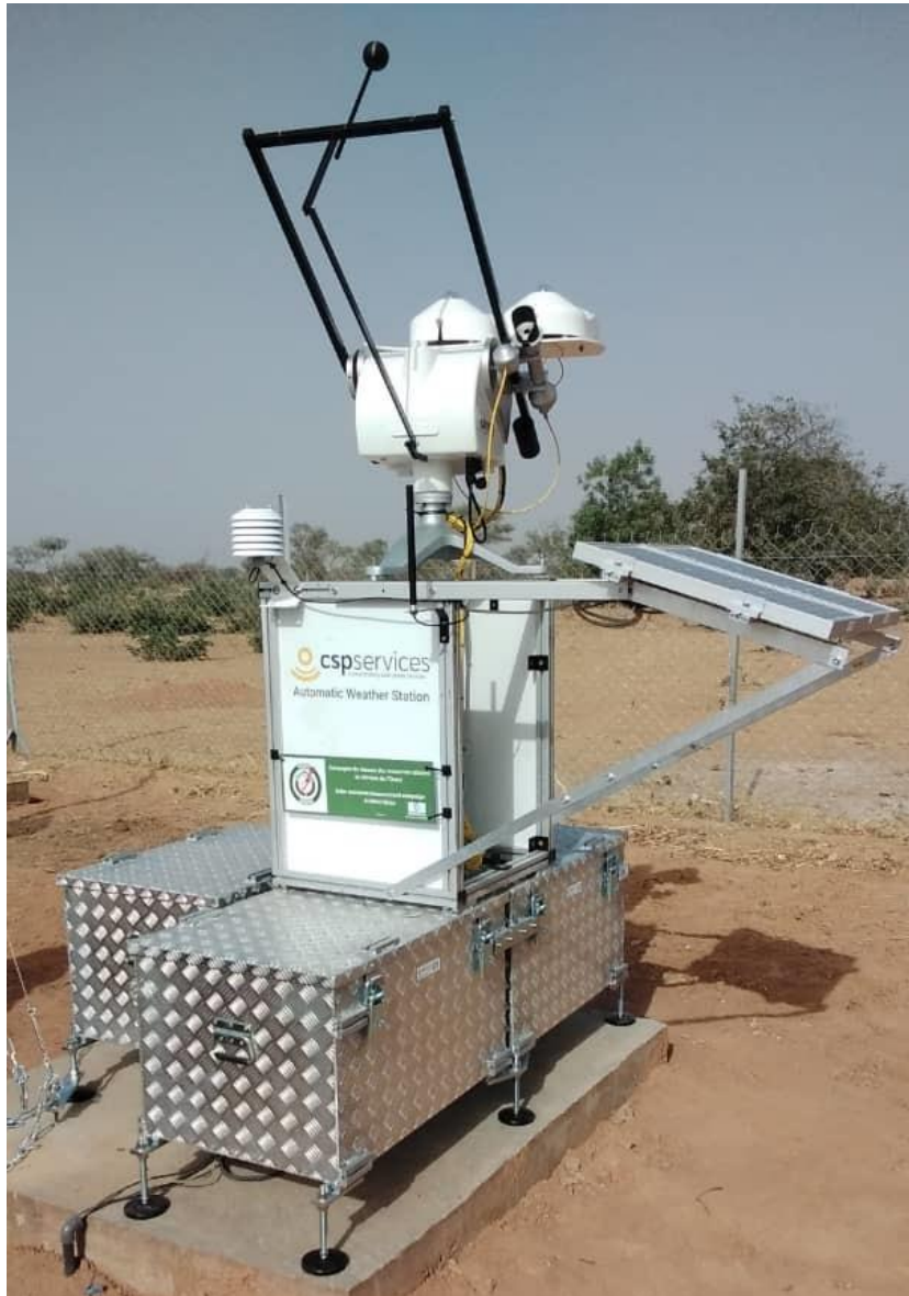
Figure 37 : Structure de montage, suiveur solaire, capteurs et boîtier de contrôle avec le logo WAPP / Mounting structure, solar tracker, sensors and control box with WAPP logo.
