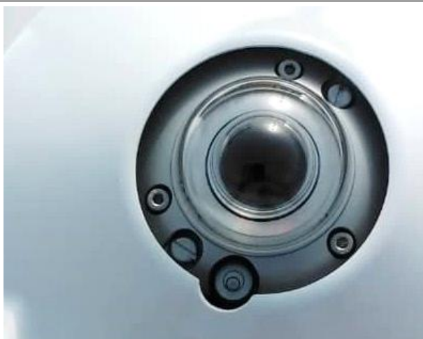
Figure 18: Mise à niveau du pyranomètre CMP10 (GHI) / CMP10 pyranometer leveling (GHI)
