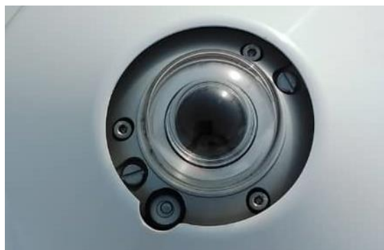
Figure 19: Mise à niveau du pyranomètre CMP10 (GHI) / CMP10 pyranometer leveling (DHI)
