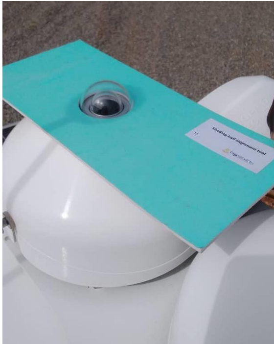
Figure 81 : Alignement de l'assemblage de l'ombrage / Shading assembly alignment.
