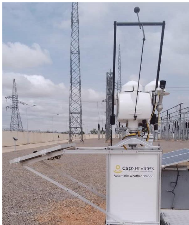
Figure 91 : Tracker solaire, capteurs et panneaux PV du système de mesure de salissure (PV-S) / Solar tracker, sensors and PV panels of soiling measurement system (PV-S).
