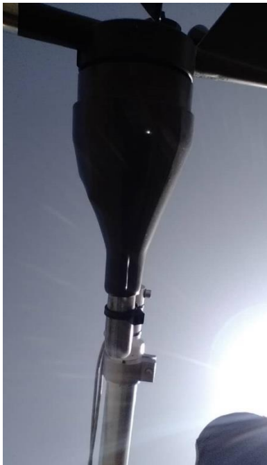
Figure 48: Marque nord du capteur de direction du vent alignée avec le cantilever de montage et la direction du nord. / Wind direction sensor north mark aligned with mounting cantilever and north direction.
