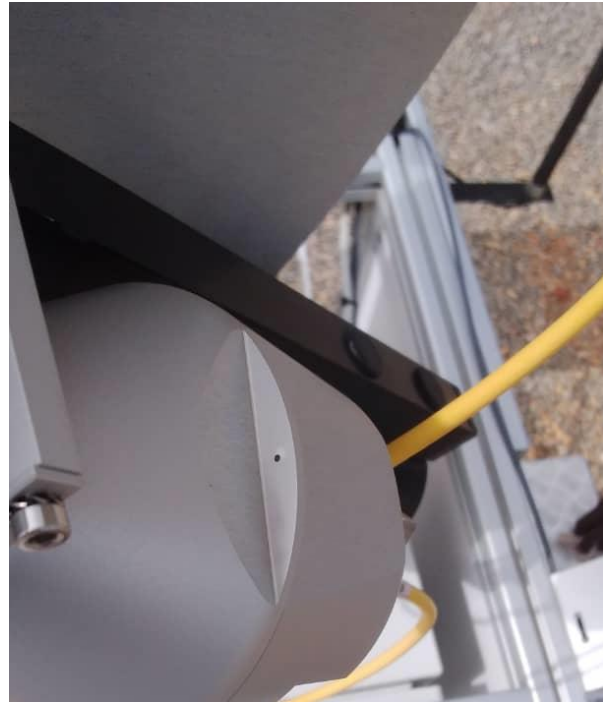
Figure 82 : Alignement du pyréliomètre / Pyrheliometer alignment.
