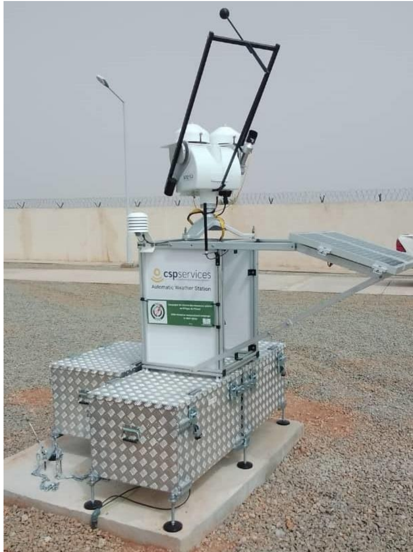
Figure 72 : Structure de montage, suiveur solaire, capteurs et boîtier de contrôle avec le logo WAPP / Mounting structure, solar tracker, sensors and control box with WAPP logo.
