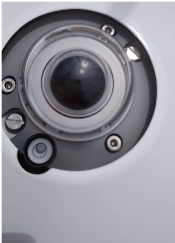
Figure 79: Mise à niveau du pyranomètre CMP10 (GHI) / CMP10 pyranometer leveling (DHI).
