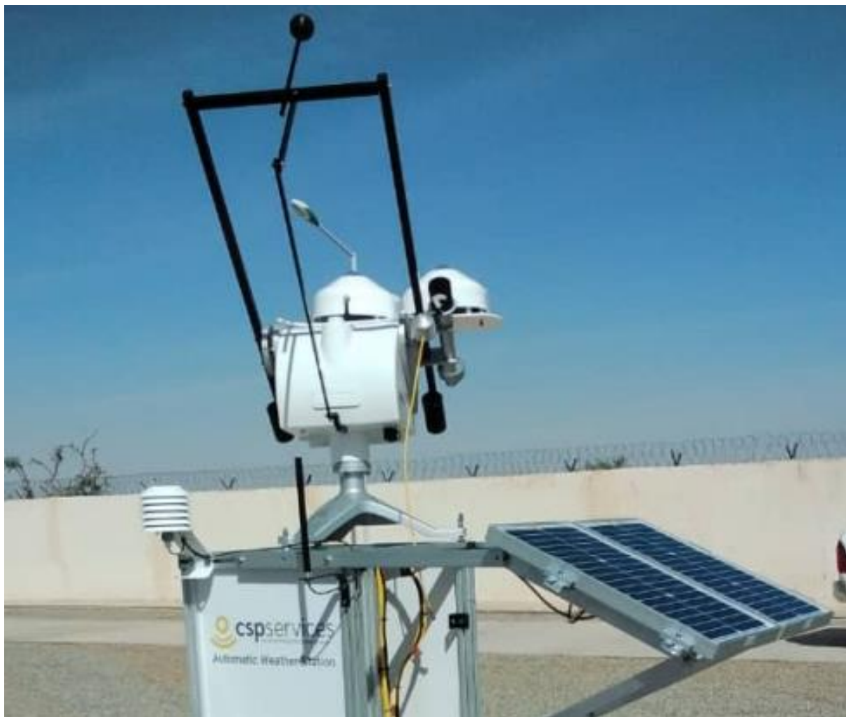
Figure 71 : Tracker solaire, capteurs et panneaux PV du système de mesure de salissure (PV-S) / Solar tracker, sensors and PV panels of soiling measurement system (PV-S).
