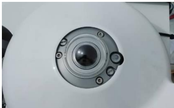
Figure 54: Mise à niveau du pyranomètre CMP10 (GHI) / CMP10 pyranometer leveling (DHI).
