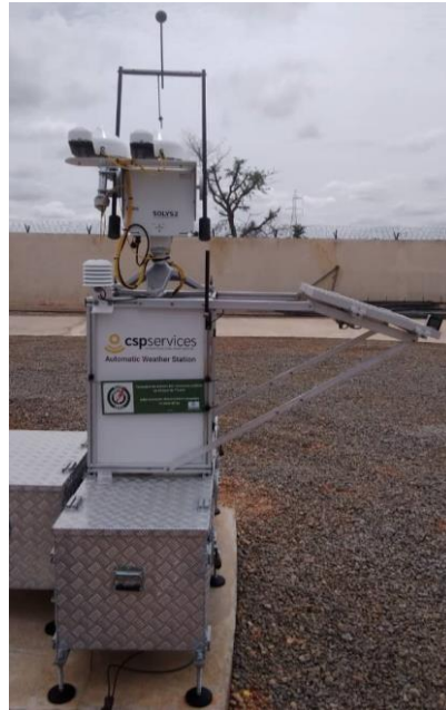
Figure 92 : Structure de montage, tracker solaire, capteurs et boîtier de contrôle / Mounting structure, solar tracker, sensors and control box.
