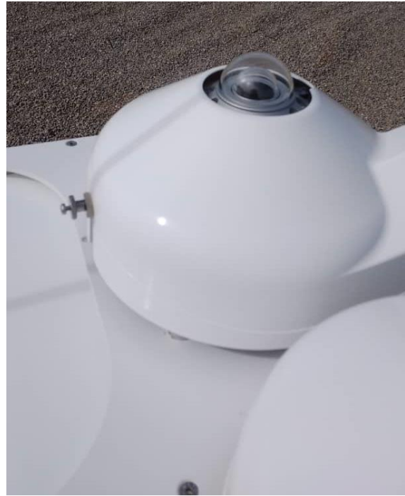
Figure 78: Pyranomètres et ventilations sur le tracker solaire / Pyranometers and ventilation units on solar tracker.
