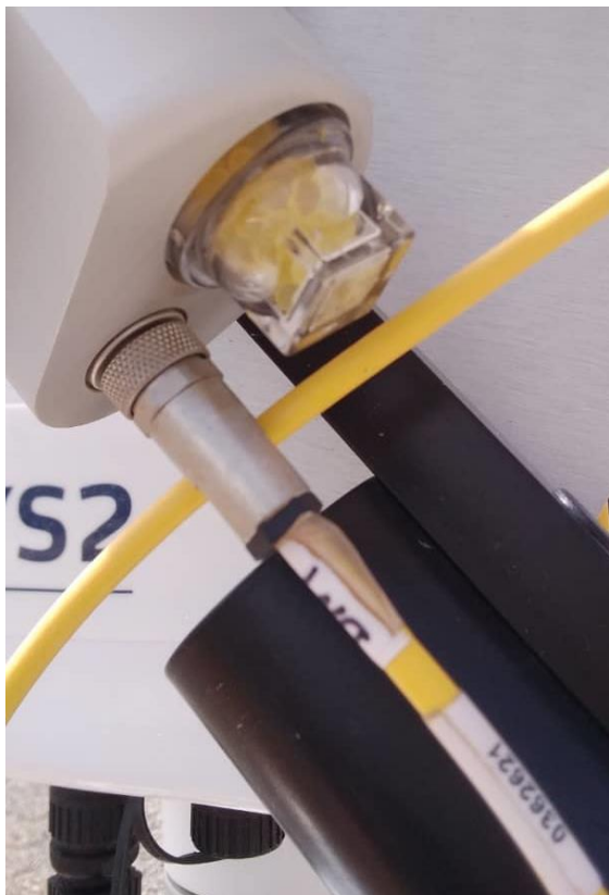
Figure 83 : Changement du dessiccant de pyréliomètre / Change of pyrheliometer desiccant.
