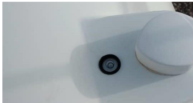
Figure 55: Mise à niveau du tracker / Tracker leveling.
