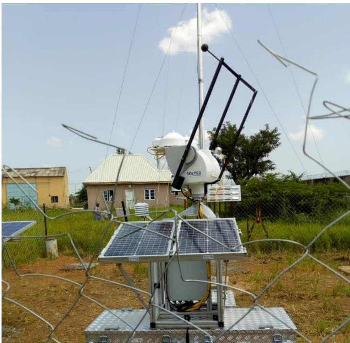
**Figure 36 : Tracker solaire, capteurs et panneaux PV du système de mesure de salissure (PV-S) / Solar tracker, sensors and PV panels of soiling measurement system (PV-S).**
