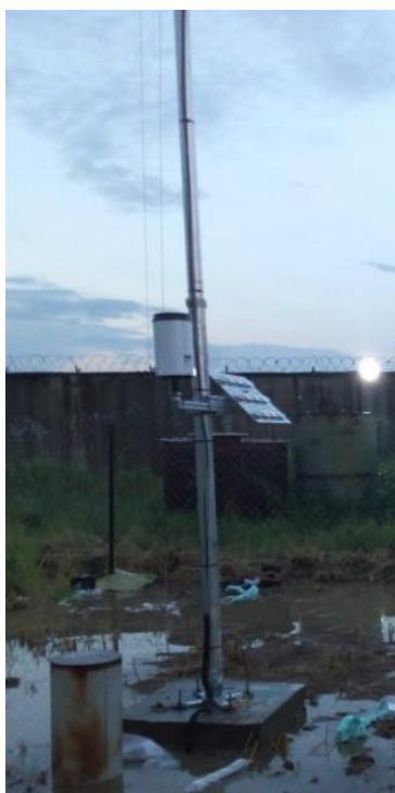
**Figure 15: Mât du vent installé capteur de direction du vent orienté vers le nord / Wind mast erected; wind direction sensor orientated to North**
