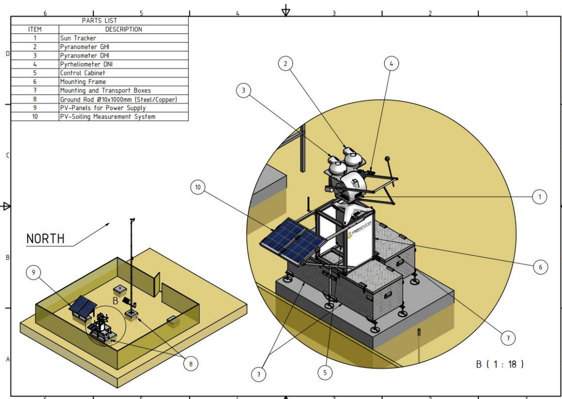
**Figure 5: Disposition de la station météorologique automatique Tier1 : Capteurs d'irradiance, système de mesure du taux de salissure PV, panneaux PV pour l'alimentation électrique / Tier1 automatic weather station layout: Irradiance sensors, PV soiling rate measurement system, PV panels for power supply.**
