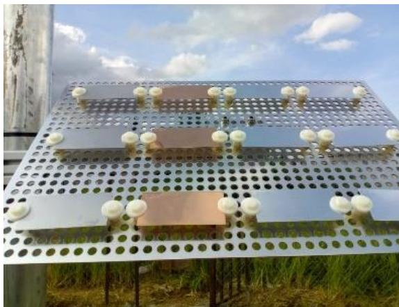
**Figure 34: Echantillonneur de corrosion / Corrosion sampler.**
