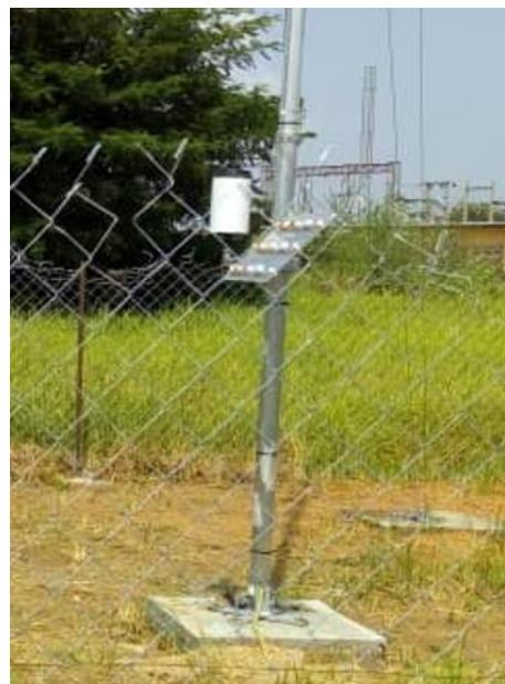
**Figure 38: Base de mât de mesure du vent, capteur de pluie et échantillonneur de corrosion / Wind mast foot, rain sensor and corrosion sampler.**
