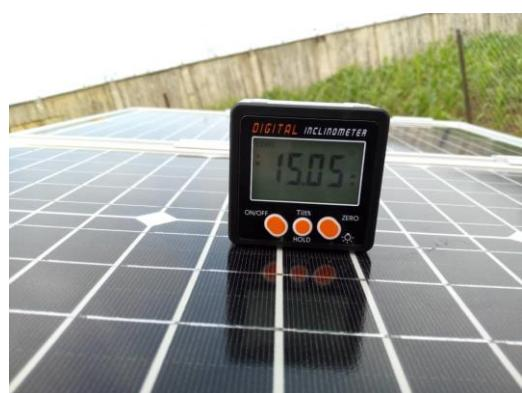
**Figure 33: Structure de support PV-S avec un angle d'inclinaison de 15° vers le sud / PV-S support structure with 15° tilt angle towards South.**
