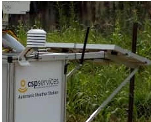
**Figure 29: Capteur T/RH et antenne du modem / T/RH sensor and modem antenna**
