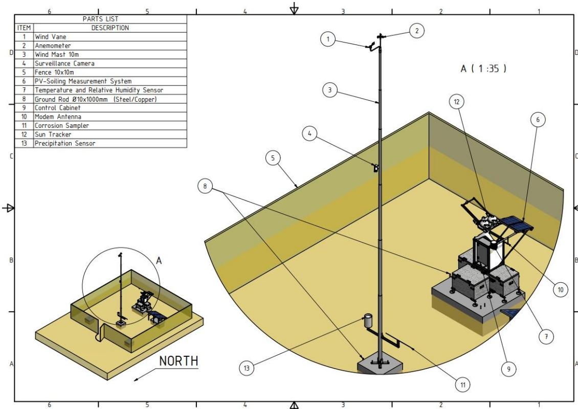
**Figure 6: Disposition de la station météorologique automatique Tier1 : détails du mât éolien de mesure et des capteurs de vent / Tier1 automatic weather station layout: wind mast and wind sensors details.**
