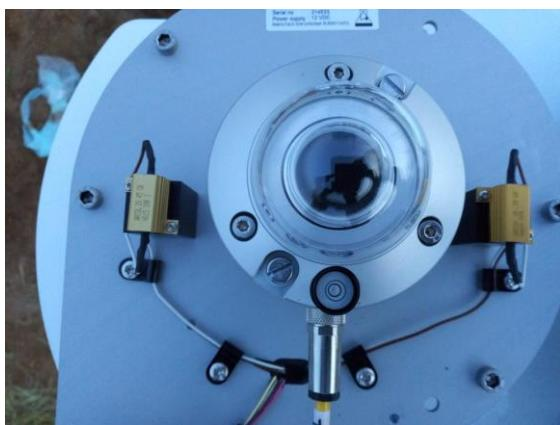
**Figure 19: Mise à niveau du pyranomètre CMP10 (DHI) / CMP10 pyranometer leveling (DHI)**
