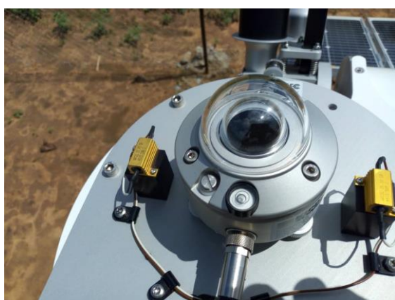
Figure 19: Mise à niveau du pyromètre CMP10 (GHI) / CMP10 pyranometer leveling (DHI)
