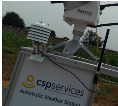
Figure 29: Capteur T/RH et antenne du modem / T/RH sensor and modem antenna
