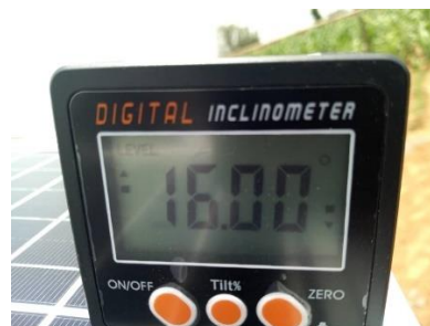
Figure 33: Structure de support PV-S avec un angle d'inclinaison de 16° vers le sud / PV-S support structure with 16° tilt angle towards South.
