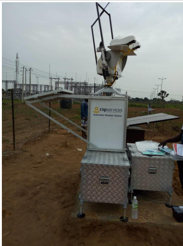
Figure 37 : Structure de montage, suiveur solaire, capteurs et boîtier de contrôle / Mounting structure, solar tracker, sensors and control box.
