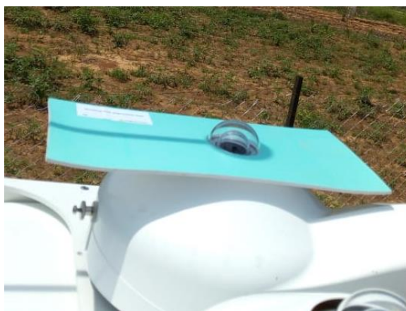
Figure 27: Mise à niveau du dispositif d'ombrage / Shading assembly alignment
