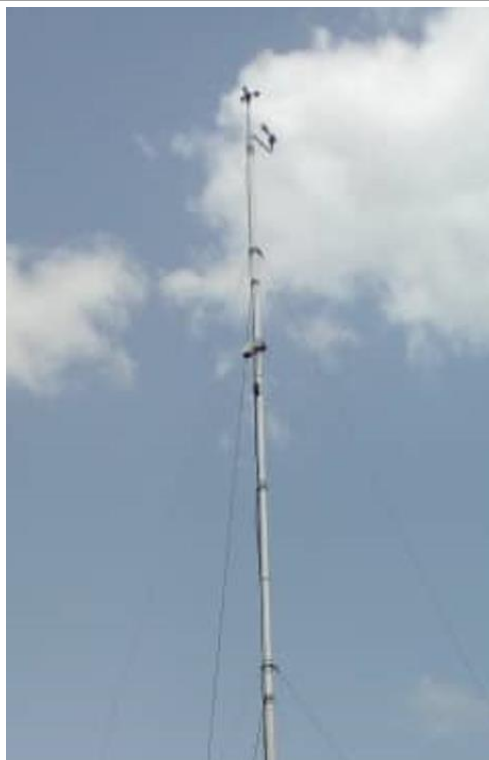
Figure 14: Capteurs de vent installés sur le mât du vent / Wind sensors installed on wind mast
