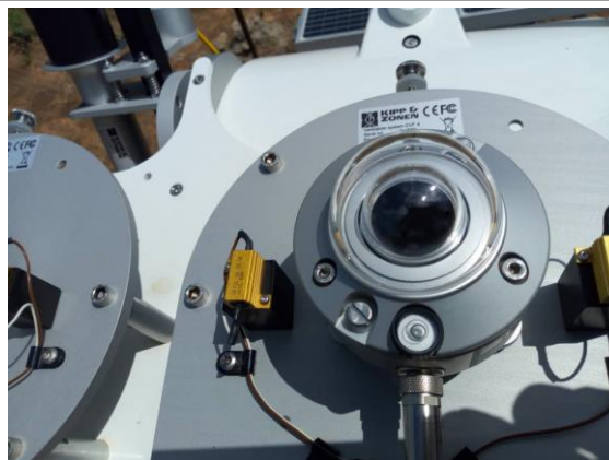
Figure 18: Mise à niveau du pyromètre CMP10 (GHI) / CMP10 pyranometer leveling (GHI)
