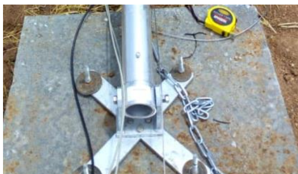
Figure 47 : Fondations du mât du vent, câble de terre fixé au boulon de terre, tube de protection pour les câbles du mât du vent / Wind mast foundations, ground cable fixed to ground bolt, protective tube for wind mast cables.
