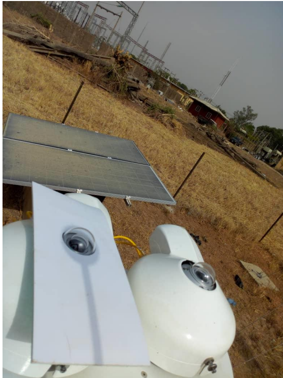
Figure 80: Alignement de l'assemblage de l'ombrage / Shading assembly alignment.
