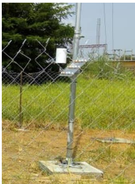
Figure 73: Base de mât de mesure du vent, capteur de pluie et échantillonneur de corrosion / Wind mast foot, rain sensor and corrosion sampler.
