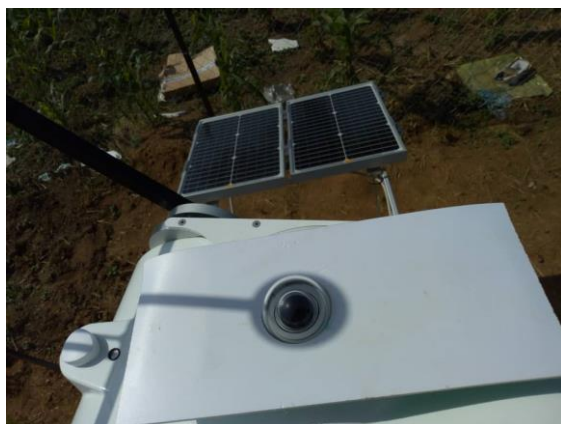
Figure 62: Mise à niveau du dispositif d'ombrage / Shading assembly alignment.
