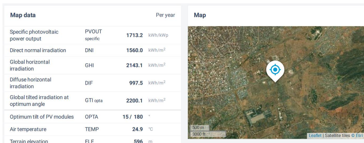
Figure 42: Valeurs moyennes annuelles obtenues à partir du Global Solar Atlas pour le site de Bauchi, Nigeria / Yearly average values obtained from the Global Solar Atlas for the site in Bauchi, Nigeria.
