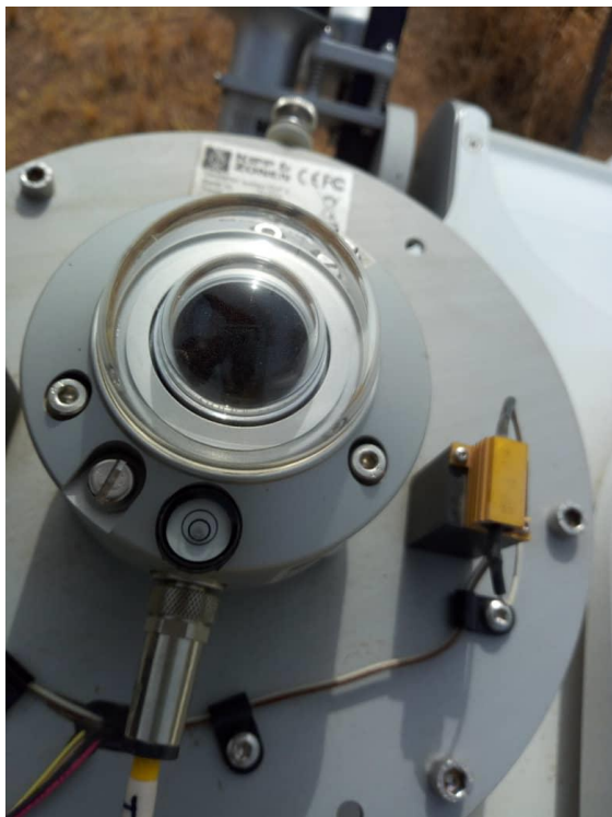
Figure 78: Mise à niveau du pyranomètre CMP10 (GHI) / CMP10 pyranometer leveling (DHI).
