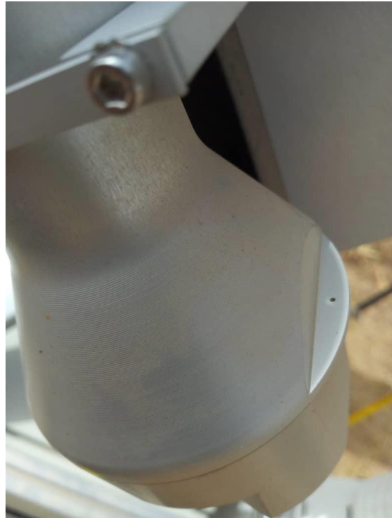
Figure 81 : Alignement du pyrhéliomètre / Pyrheliometer alignment.
