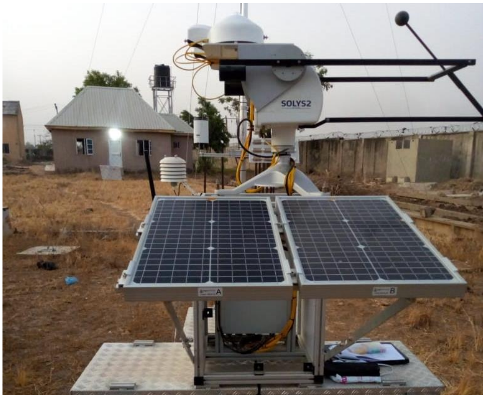
Figure 90 : Tracker solaire, capteurs et panneaux PV du système de mesure de salissure (PV-S) / Solar tracker, sensors and PV panels of soiling measurement system (PV-S).
