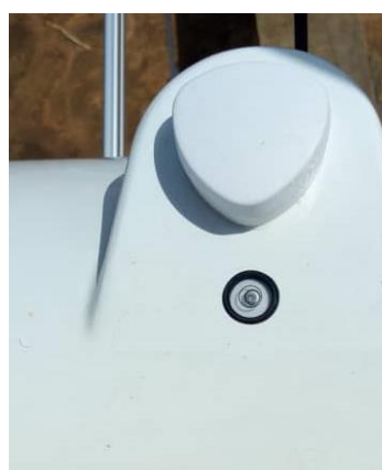
Figure 55: Mise à niveau du tracker / Tracker leveling.
