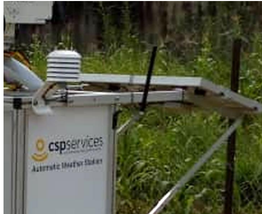
Figure 64: Capteur T/RH et antenne du modem / T/RH sensor and modem antenna.
