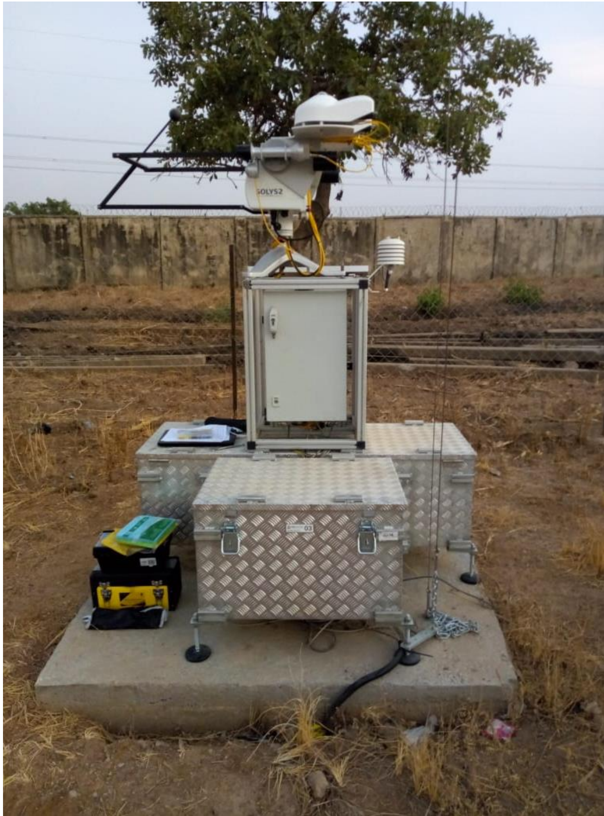
Figure 91 : Structure de montage, tracker solaire, capteurs et boîtier de contrôle / Mounting structure, solar tracker, sensors and control box.
