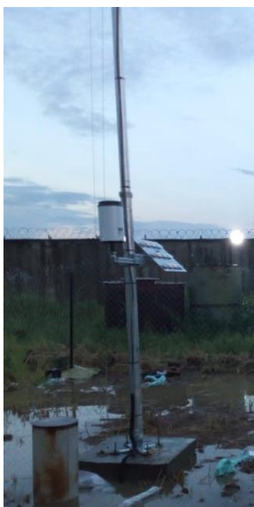
Figure 50: Mât du vent installé capteur de direction du vent orienté vers le nord / Wind mast erected; wind direction sensor orientated to north.
