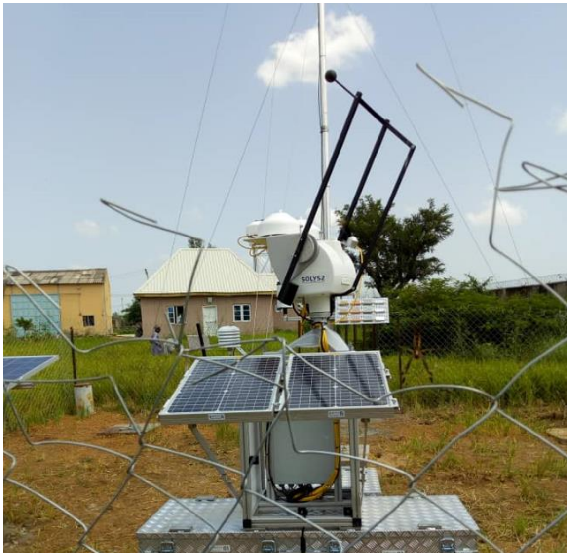
Figure 71 : Tracker solaire, capteurs et panneaux PV du système de mesure de salissure (PV-S) / Solar tracker, sensors and PV panels of soiling measurement system (PV-S).
