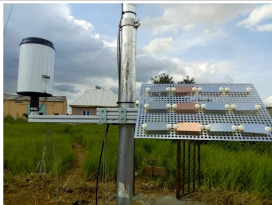
Figure 59: Capteur de pluie et échantillonneur de corrosion / Rain sensor and corrosion sampler.
