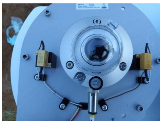
Figure 54: Mise à niveau du pyranomètre CMP10 (DHI) / CMP10 pyranometer leveling (DHI).
