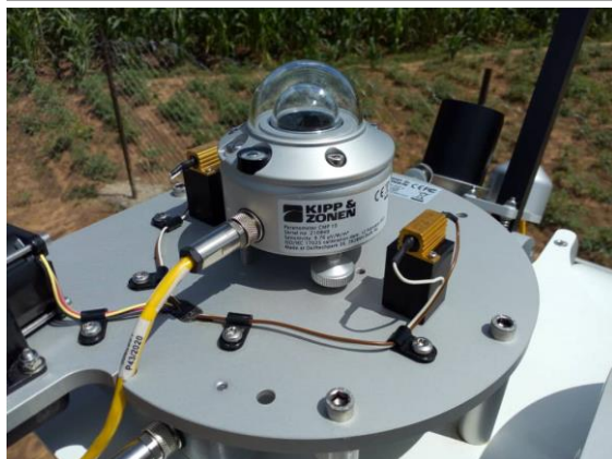
Figure 52: Numéro de série du pyromètre CMP10 (DHI) / CMP10 pyranometer serial number (DHI).
