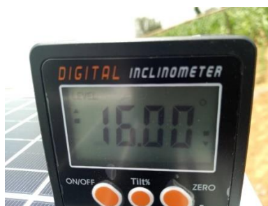
Figure 68: Structure de support PV-S avec un angle d'inclinaison de 16° vers le sud / PV-S support structure with 16° tilt angle towards south.
