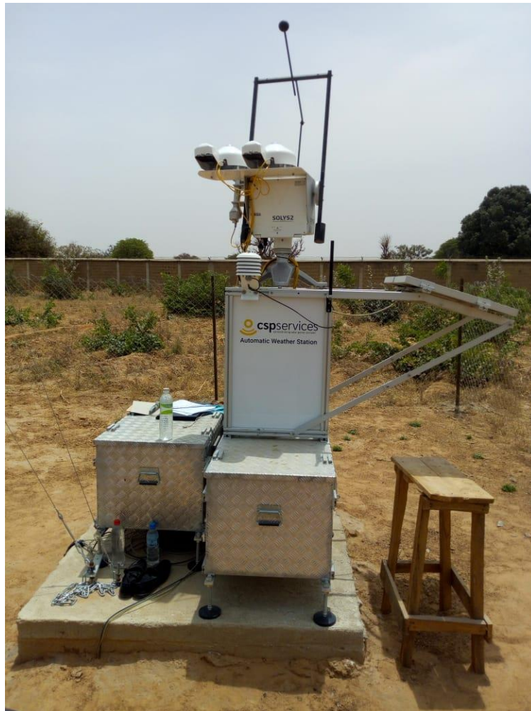
Figure 95 : Structure de montage, tracker solaire, capteurs et boîtier de contrôle / Mounting structure, solar tracker, sensors and control box.
