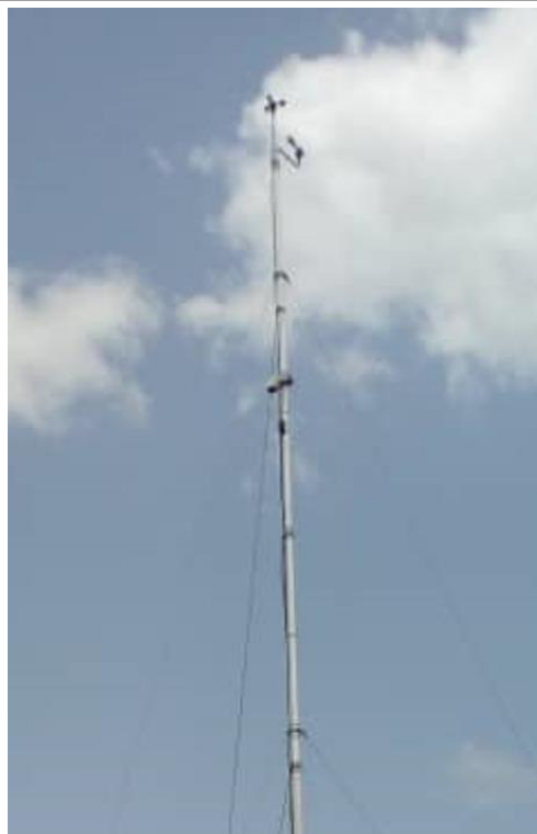
Figure 49: Capteurs de vent installés sur le mât du vent / Wind sensors installed on wind mast.
