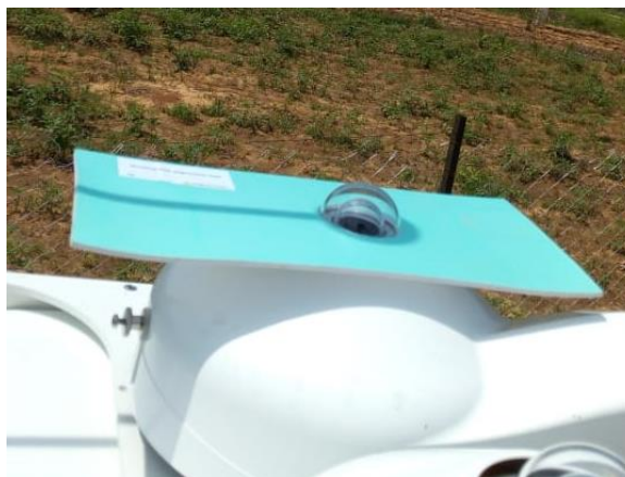
Figure 62: Mise à niveau du dispositif d'ombrage / Shading assembly alignment.
