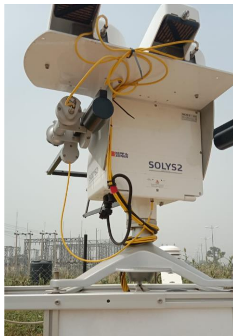
Figure 77: Conduite des câbles du tracker solaire avant ajustement / Solar tracker cable guiding before adjustment.
