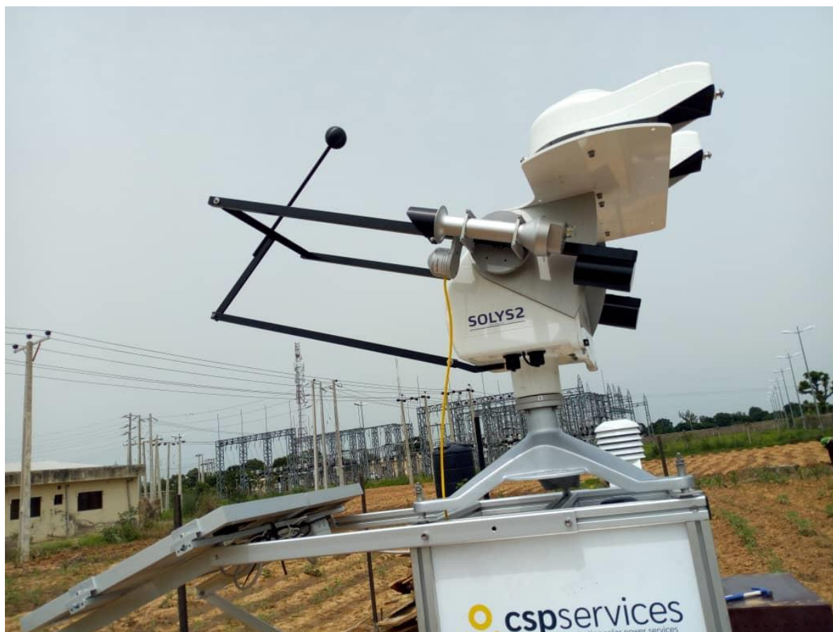
Figure 71 : Tracker solaire, capteurs et panneaux PV du système de mesure de salissure (PV-S) / Solar tracker, sensors and PV panels of soiling measurement system (PV-S).
