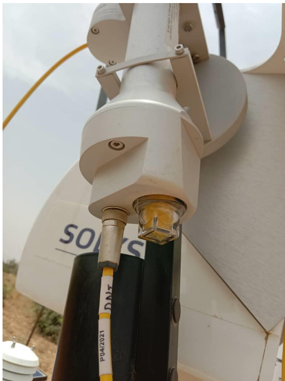
Figure 86: Changement du dissécatant de Pyrheliometer / Change of pyrheliometer dissecant.
