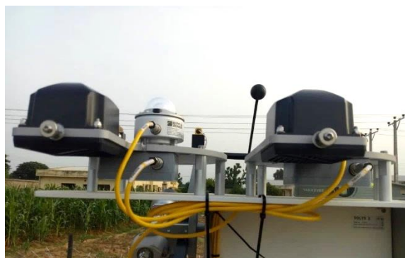
Figure 81: Pyranomètres et ventilations sur le tracker solaire / Pyranometers and ventilation units on solar tracker.
