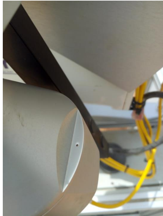
Figure 85: Alignement du pyrhéliomètre / Pyrheliometer alignment.
