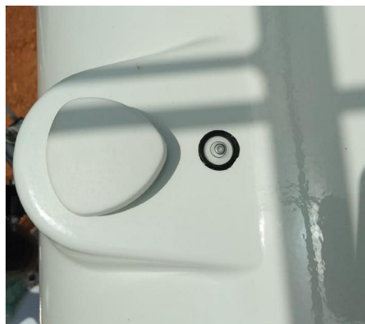
Figure 20: Mise à niveau du tracker / Tracker leveling
