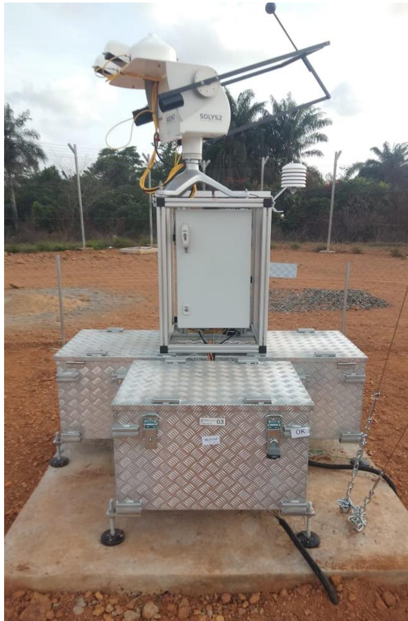
Figure 37 : Structure de montage, suiveur solaire, capteurs et boîtier de contrôle / Mounting structure, solar tracker, sensors and control box.
