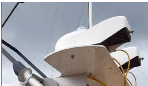
Figure 78: Pyranomètres et ventilations sur le tracker solaire / Pyranometers and ventilation units on solar tracker.
