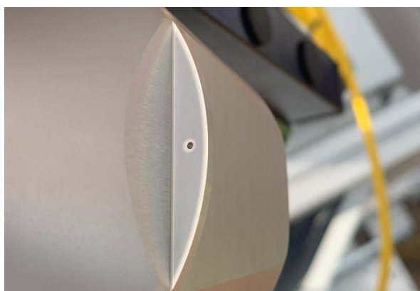
Figure 63 : Alignement du pyrhéliomètre / Pyrheliometer alignment.
