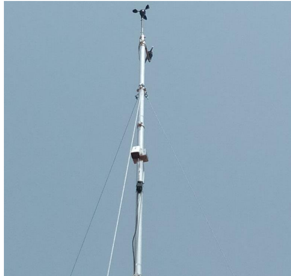
Figure 49: Capteurs de vent installés sur le mât du vent / Wind sensors installed on wind mast.
