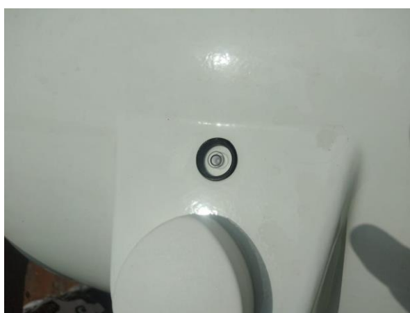
Figure 55: Mise à niveau du tracker / Tracker leveling.
