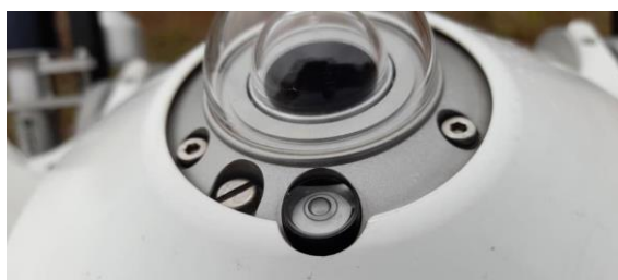
Figure 79: Mise à niveau du pyranomètre CMP10 (GHI) / CMP10 pyranometer leveling (DHI).
