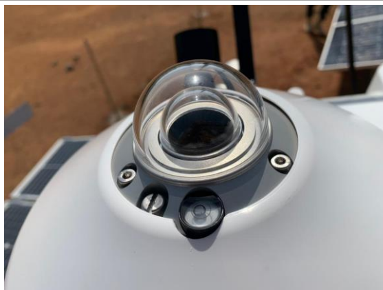
Figure 53: Mise à niveau du pyranomètre CMP10 (GHI) / CMP10 pyranometer leveling (GHI).
