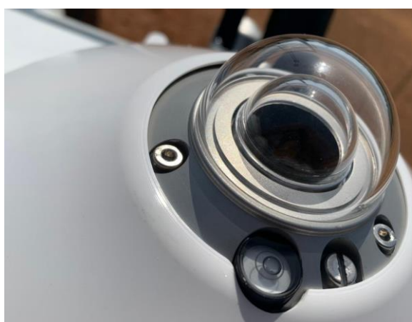
Figure 54: Mise à niveau du pyranomètre CMP10 (GHI) / CMP10 pyranometer leveling (DHI).
