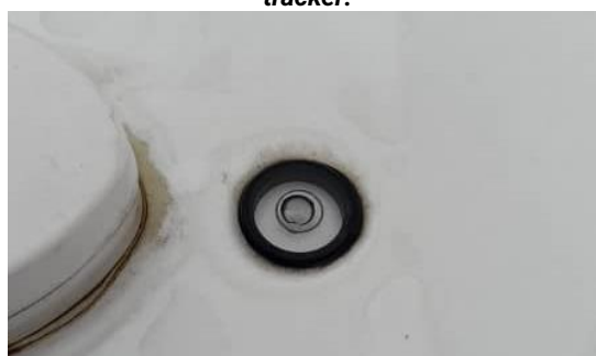
Figure 80: Mise à niveau du tracker / Tracker leveling.
