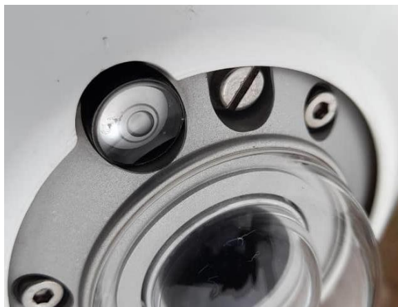
Figure 79: Mise à niveau du pyranomètre CMP10 (GHI) / CMP10 pyranometer leveling (DHI).
