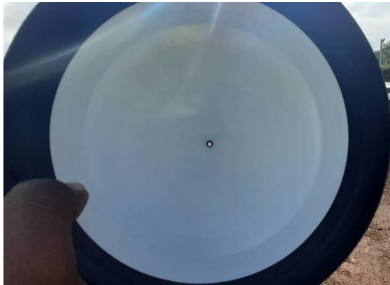
Figure 83: Nettoyage du capteur de pluie / Rain sensor cleaning.
