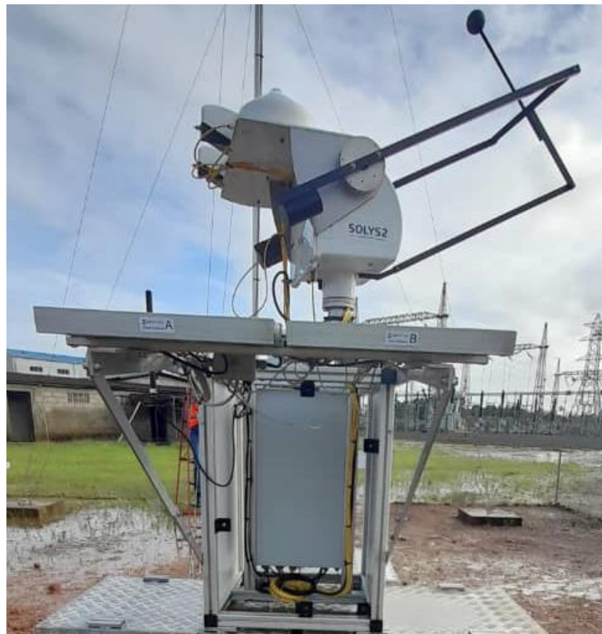
Figure 89 : Tracker solaire, capteurs et panneaux PV du système de mesure de salissure (PV-S) / Solar tracker, sensors and PV panels of soiling measurement system (PV-S).
