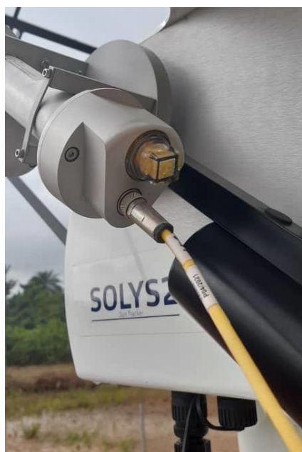
Figure 81 : Changement du dessiccant de pyréliomètre / Change of pyréliometer desiccant.
