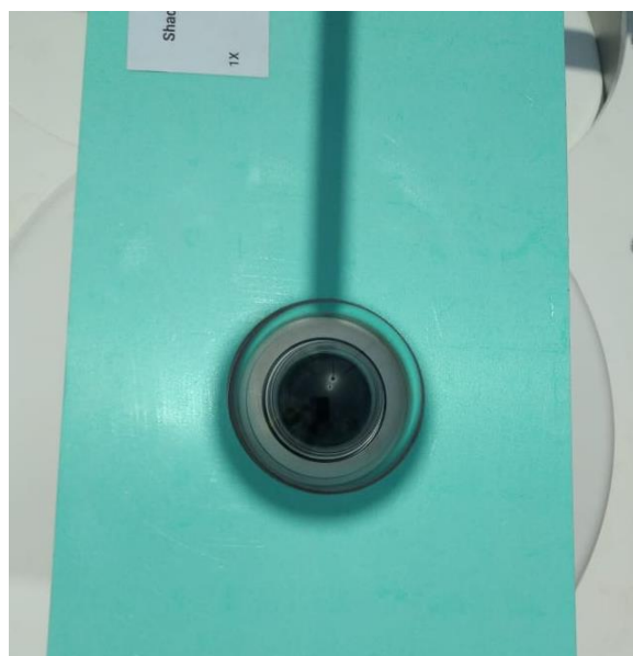
Figure 62: Mise à niveau du dispositif d'ombrage / Shading assembly alignment.
