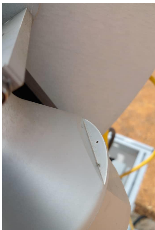
Figure 95: Vérification de l'alignement correct du pyrhéliomètre / Check of correct pyrheliometer alignment.
