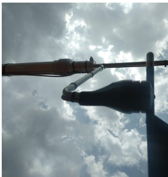
Figure 48: Marque nord du capteur de direction du vent alignée avec le cantilever de montage et la direction du nord. / Wind direction sensor north mark aligned with mounting cantilever and north direction.
