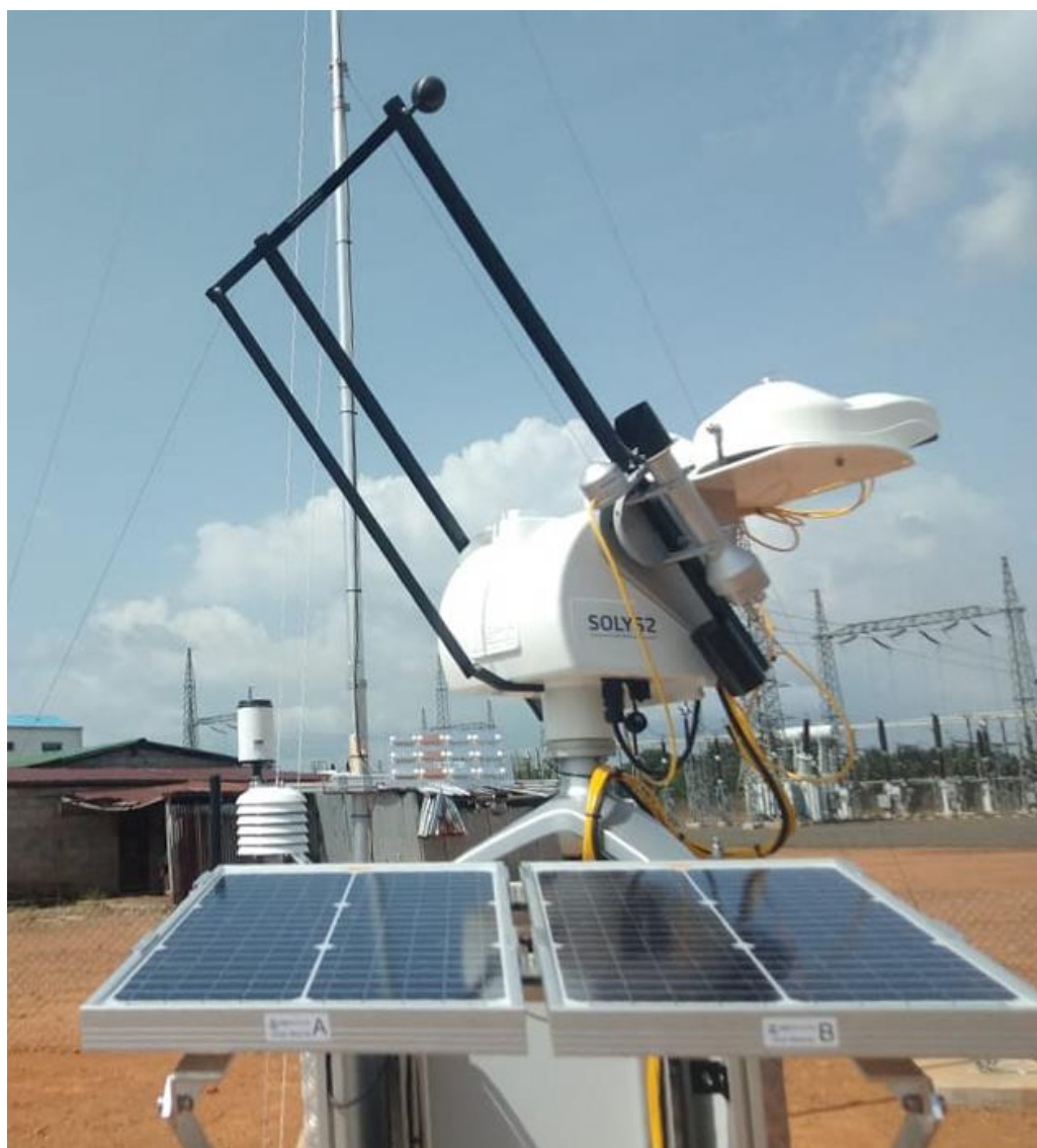
Figure 71 : Tracker solaire, capteurs et panneaux PV du système de mesure de salissure (PV-S) / Solar tracker, sensors and PV panels of soiling measurement system (PV-S).
