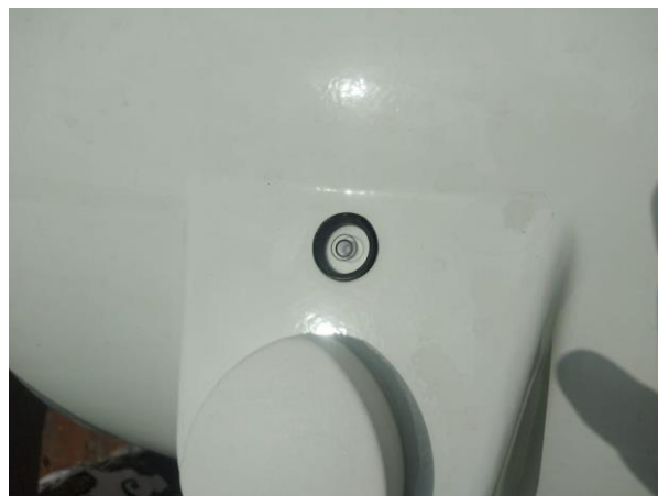
Figure 20: Mise à niveau du tracker / Tracker leveling
