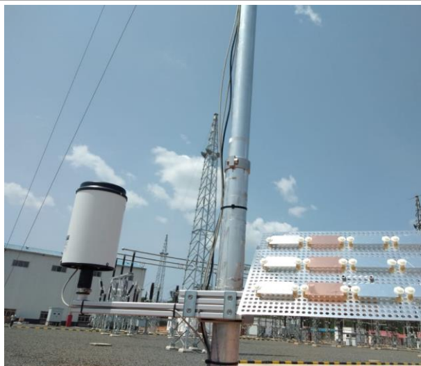
Figure 24: Capteur de pluie et échantillonneur de corrosion / Rain sensor and corrosion sampler
