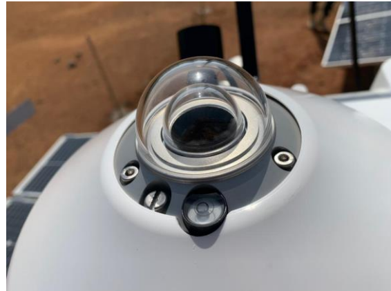
Figure 18: Mise à niveau du pyranomètre CMP10 (GHI) / CMP10 pyranometer leveling (GHI)
