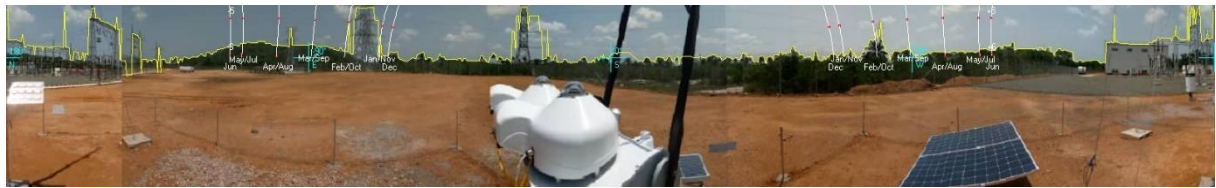
Figure 3: Ligne d'horizon du point de vue du pyranomètre et course du soleil tout au long de l'année / Horizon line from the perspective of the pyranometer and sun path throughout the year.
