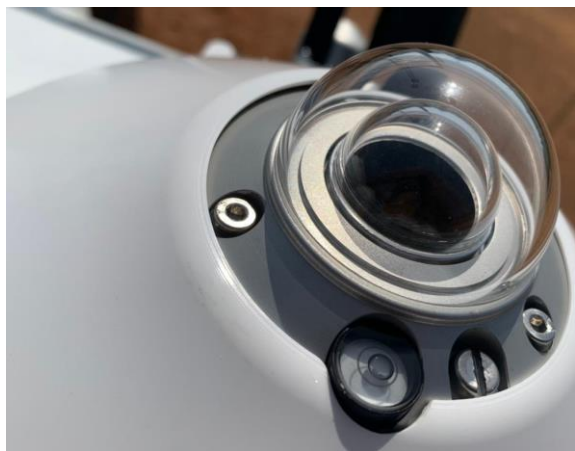
Figure 19: Mise à niveau du pyranomètre CMP10 (GHI) / CMP10 pyranometer leveling (DHI)
