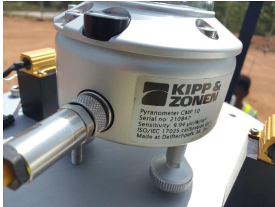
Figure 17: Numéro de série du pyranomètre CMP10 (DHI) / CMP10 pyranometer serial number (DHI)
