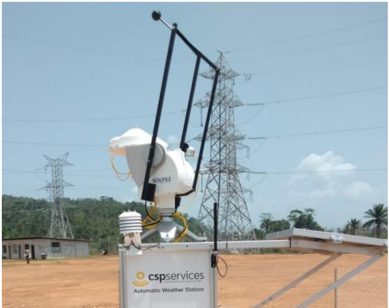
Figure 36 : Tracker solaire, capteurs et panneaux PV du système de mesure de salissure (PV-S) / Solar tracker, sensors and PV panels of soiling measurement system (PV-S).
